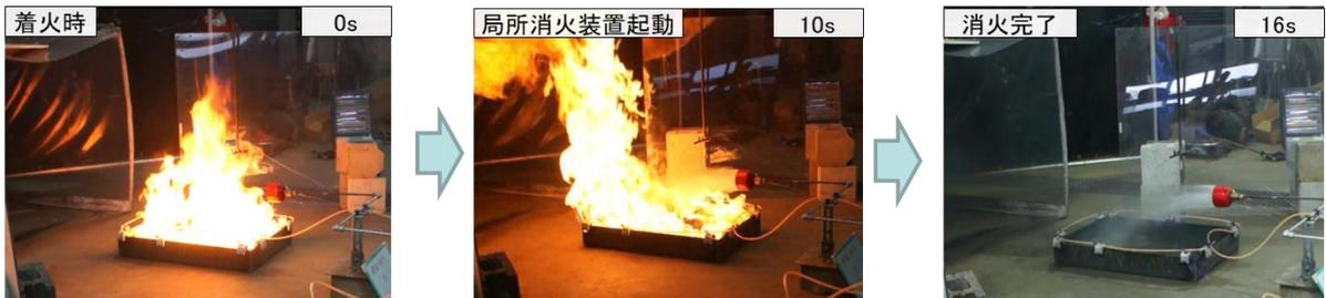
図 6. 開放空間消火試験 (代替ハロン) の経過
