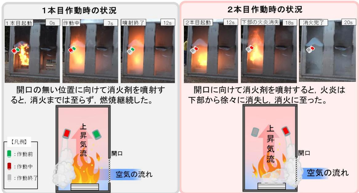
第1. 2. 4. 3-1 図 試験実施時の写真及びイメージ図
