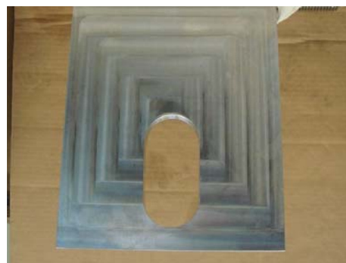
図 11 模擬ラグ B (スリット平行) 1 回目試験の試験後の供試体等の状況
