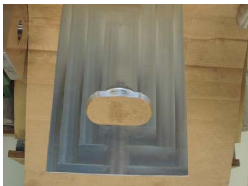
図 10 模擬ラグ A (スリット直交) 2 回目試験の試験後の供試体等の状況
