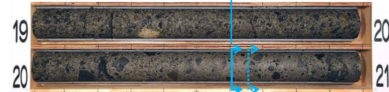
① ボーリングコア (CB-12孔 深度19m~21m)
