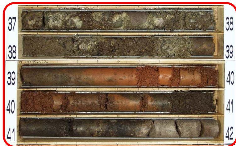
dF-a断層想定延長部の拡大コア写真
