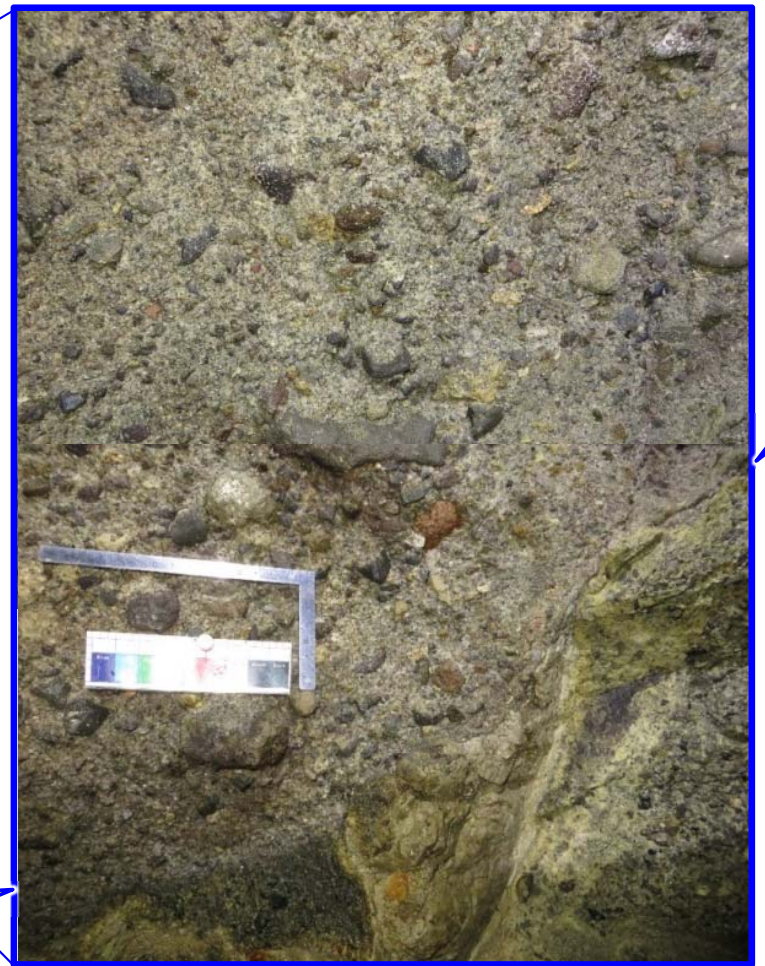
直線的なdf-2断層と凹凸のある大畑層基底面 (接写画像を上下で合成)
