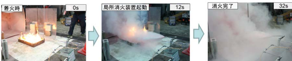
第1. 2. 2. 3-3 図 試験実施時の写真（火災源を ABC 粉末で覆えられた場合）
