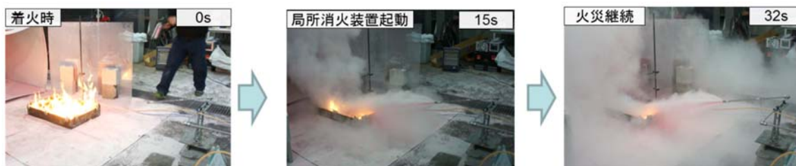
第1. 2. 2. 3-2 図 試験実施時の写真（火災源を ABC 粉末で一部覆えられない箇所がある場合）
