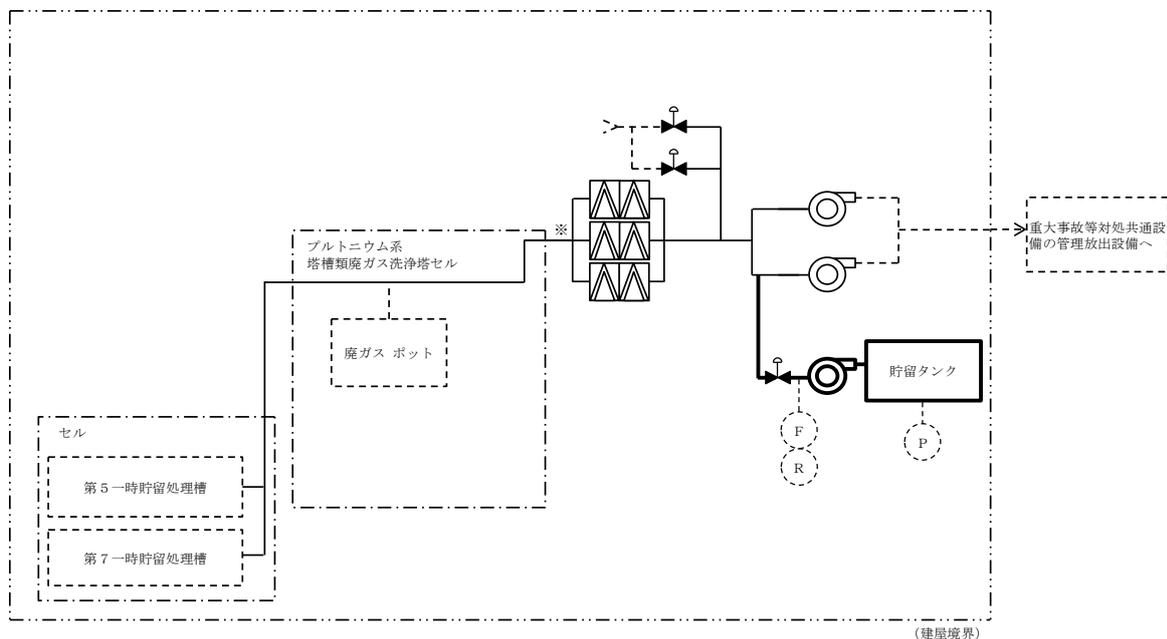
※ 気体廃棄物の廃棄施設の塔槽類廃ガス処理設備の精製建屋塔槽類廃ガス処理設備の塔槽類廃ガス処理系（プルトニウム系）
