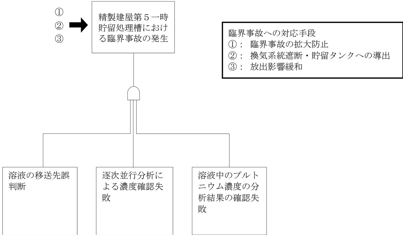
第 1.1-1 図 機能喪失原因対策分析と手順の概要（精製建屋 第5一時貯留処理槽）
