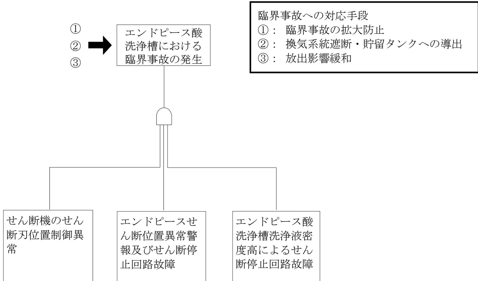
第 1.1-1 図 機能喪失原因対策分析と手順の概要（エンドピース酸洗浄槽）
