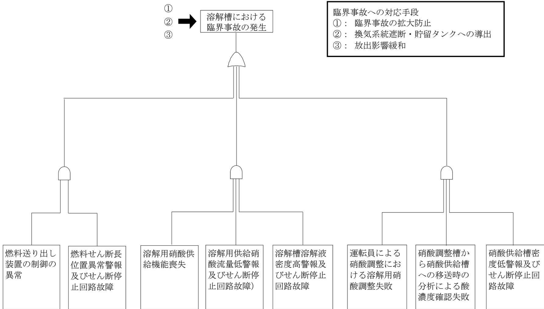
第 1.1-1 図 機能喪失原因対策分析と手順の概要（溶解槽）
