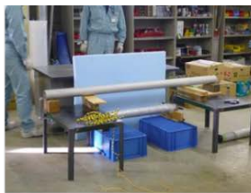
配管: R-SUS304ULC 80A SCH20S (外径89.1mm 厚さ4.0mm)
