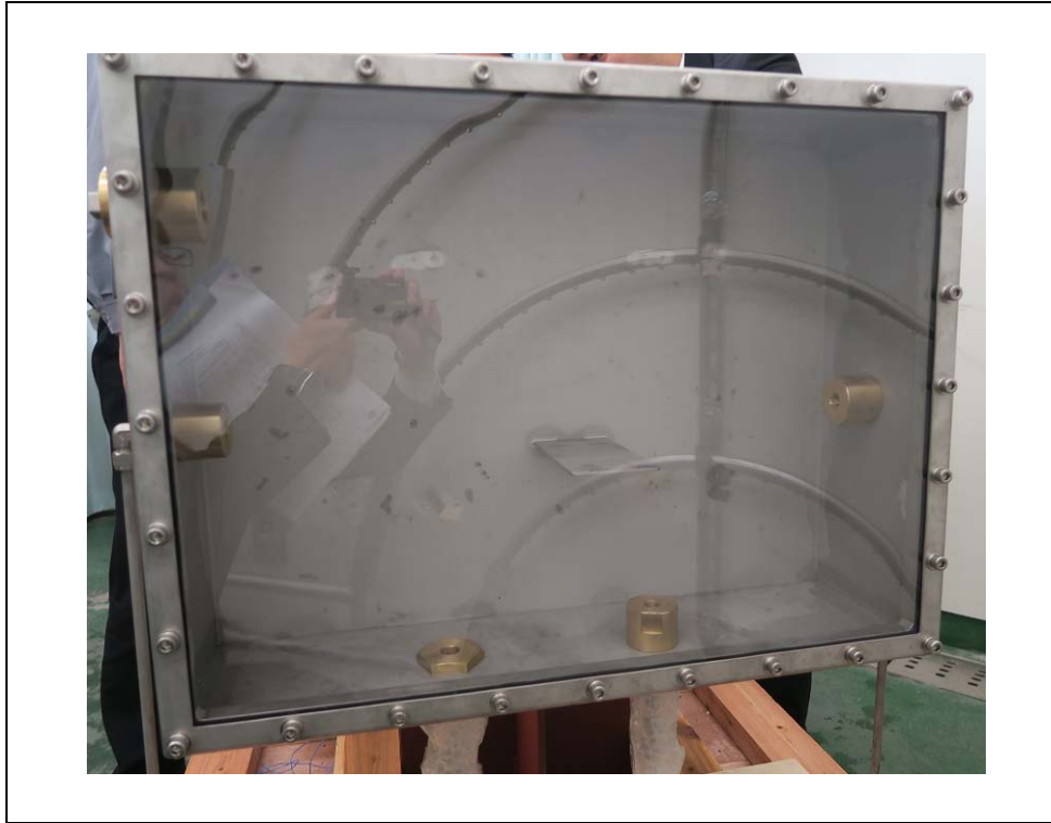
第5-2図 溢水防護板の例（イメージ写真）
