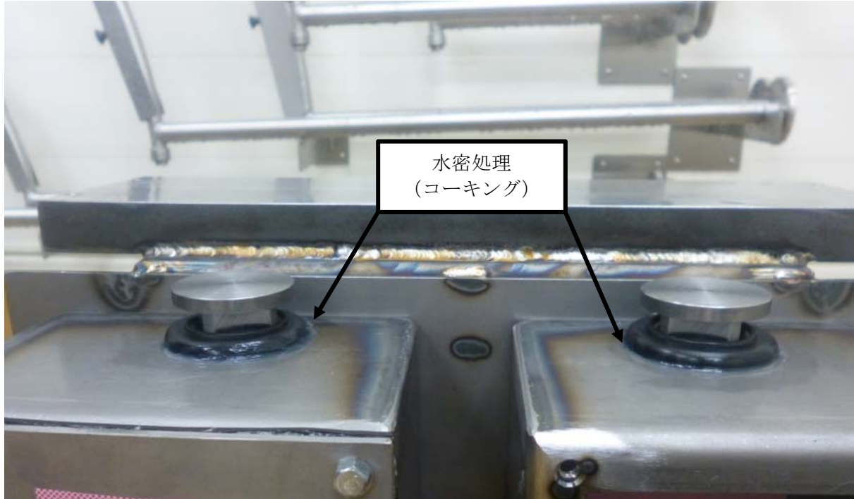
第3図 水密処理の例 (イメージ)
