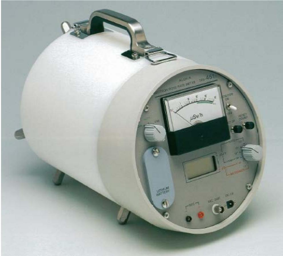
第 3 図 中性子線用サーベイメータ（S A）の外形図
