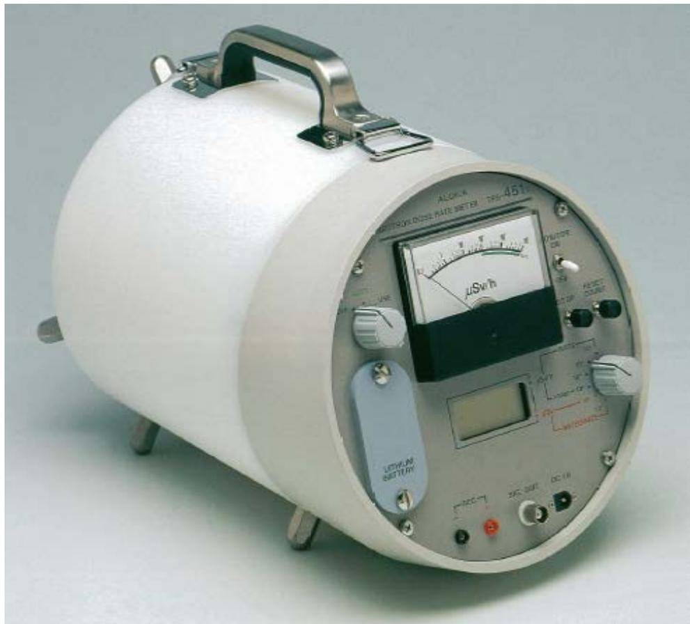
第 4 図 中性子線用サーベイメータ ( S A ) の外形図
