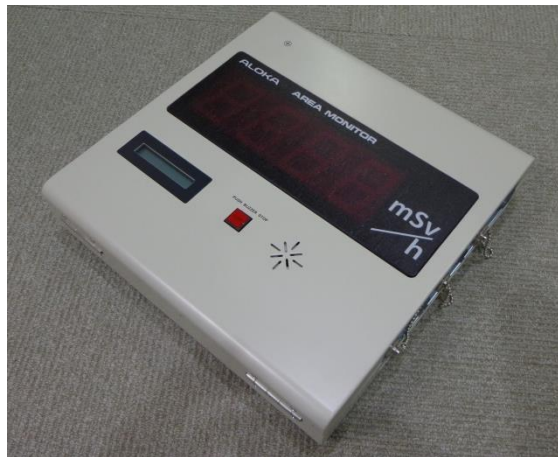
第 5 図 緊急時対策所エリアモニタ
