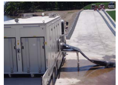
可搬型建屋外ホース接続 (300A)
