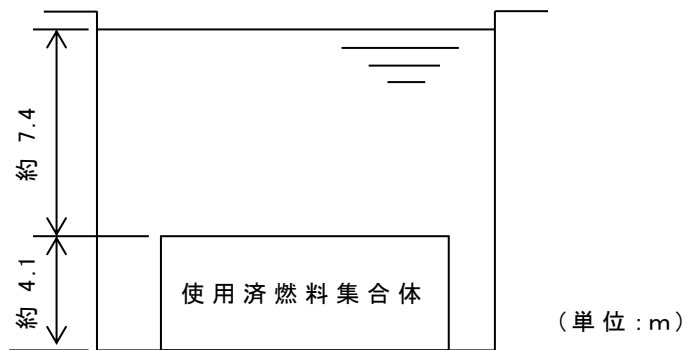
図1.2 燃料有効長頂部から水面までの水位
