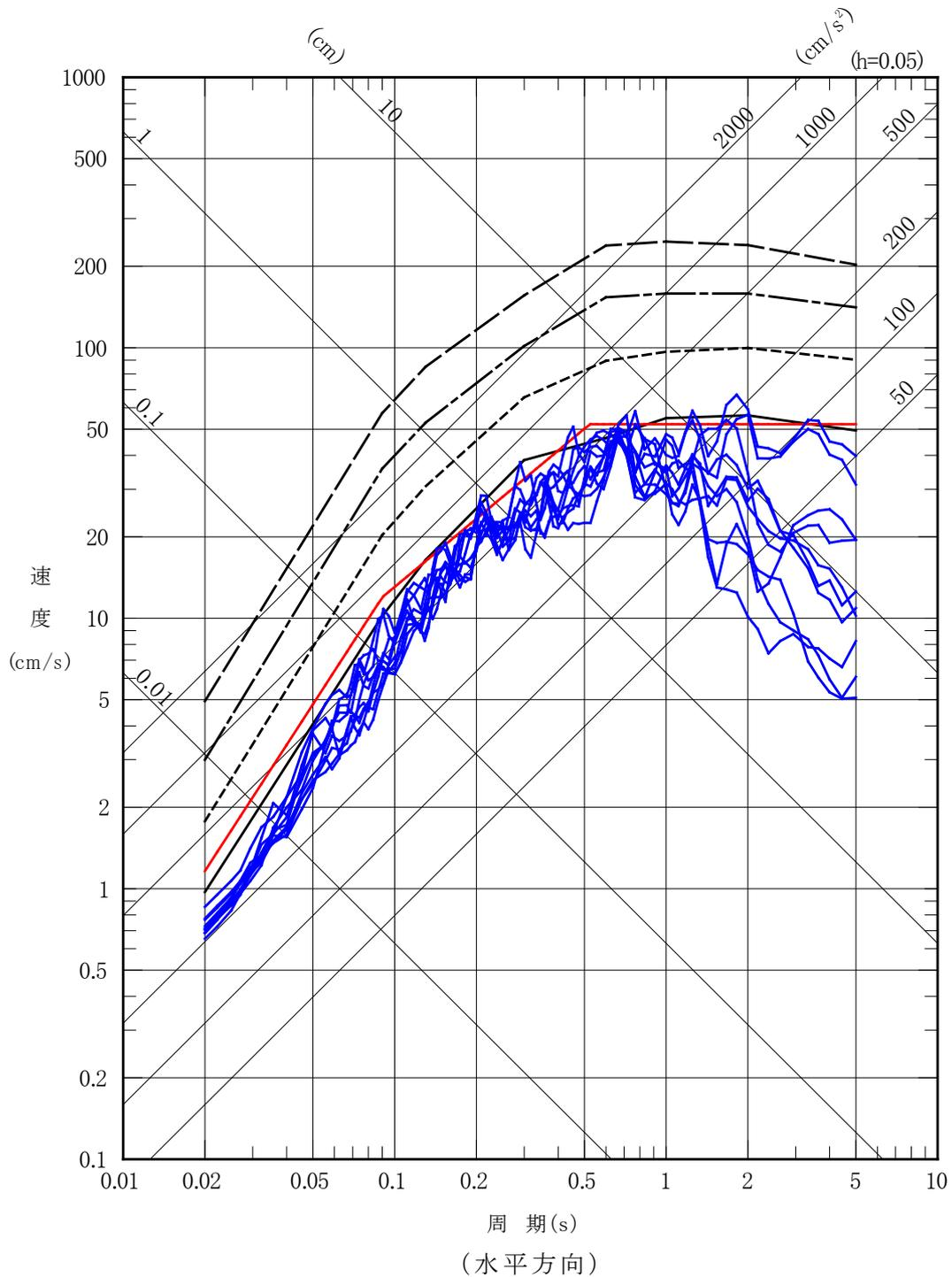
第 3 - 3 - 2 図(1) 地震ハザード評価結果
