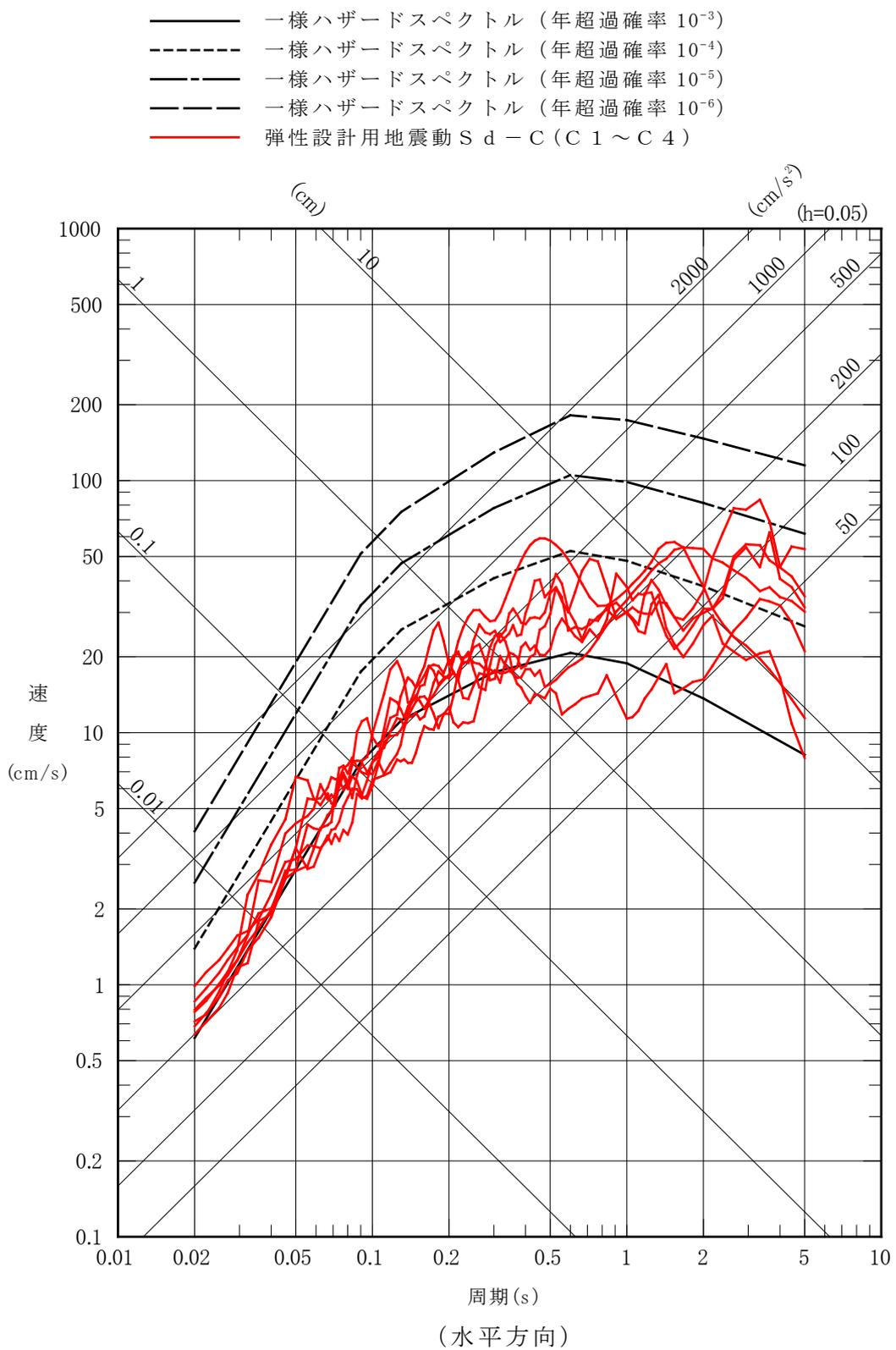
第 3 - 3 - 2 図 (3) 地震ハザード評価結果
