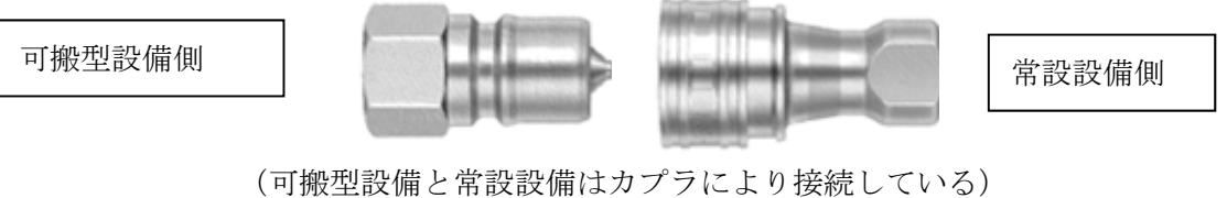
高レベル廃液ガラス固化建屋の蒸発乾固に対処するための設備における可搬型設備と常設設備の接続図 高レベル廃液ガラス固化建屋 (地下2階) その2
