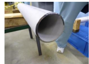
切断面 セッティングから切断に要した時間:約15分
