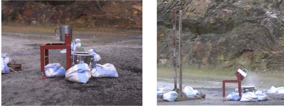
第 2.3-4 図 大量混合試験装置
