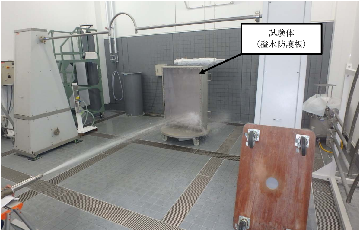
第4図 被水試験の例 (溢水防護板)
