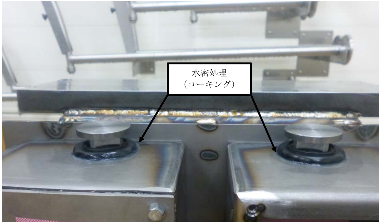
第3図 水密処理の例 (イメージ)
