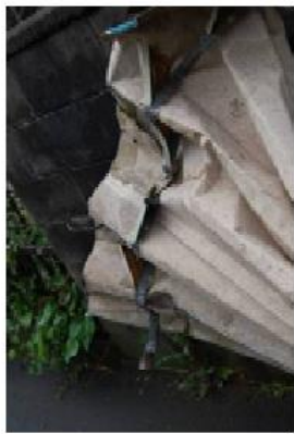
飛散した折板屋根の損傷状況
