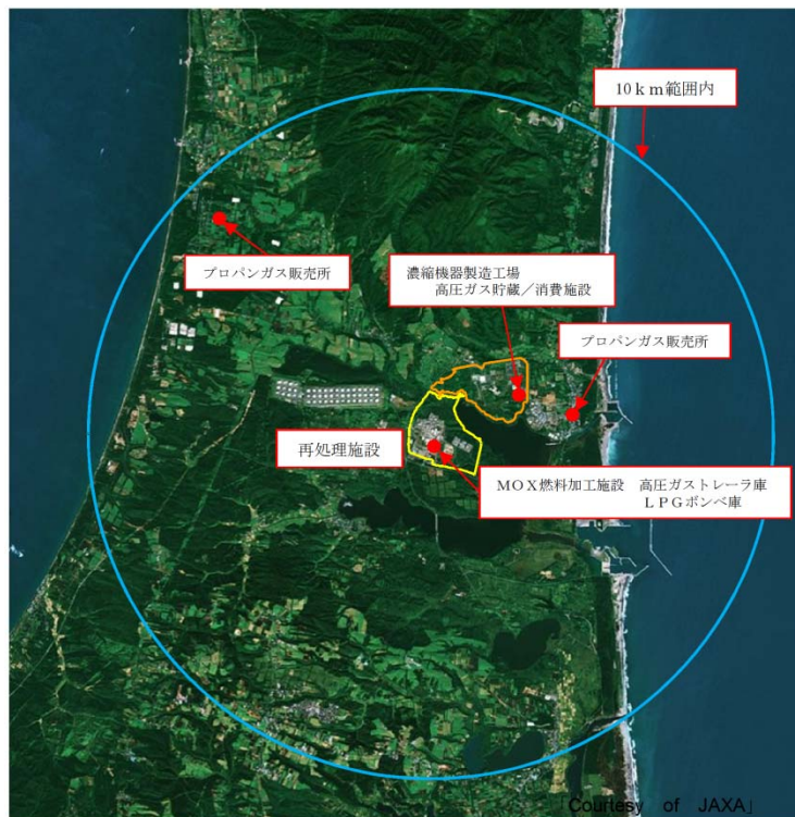
第9. 11 図 (外部火災) 高圧ガス貯蔵施設の配置概要図
