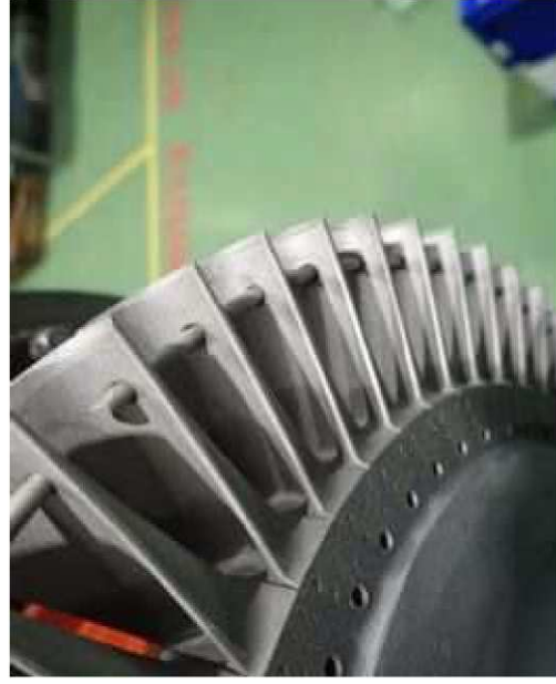
(タービンブレード (腹側) -レーシングワイヤ孔)
