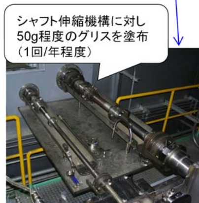
グリス塗布部拡大 【実規模試験装置】
