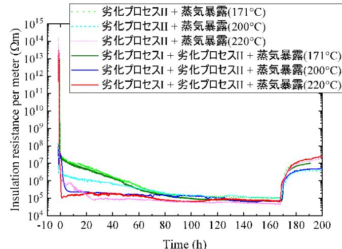
図3 国内のBWRで用いられている難燃エチレンプロピレンジエンゴム絶縁ケーブルの蒸気暴露中のケーブル長さ1m当たりの絶縁抵抗の変化<sup>[4]</sup>
