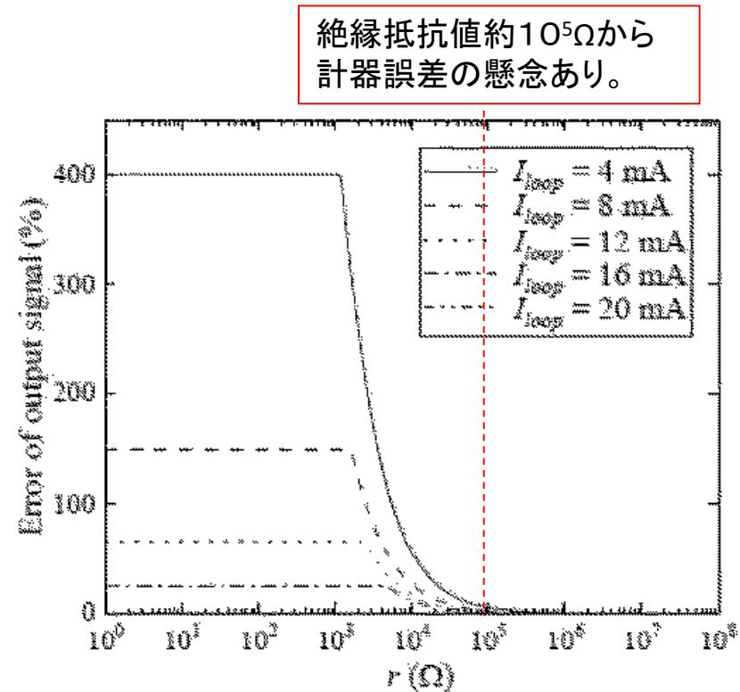
図 5 伝送回路の絶縁抵抗と出力信号の誤差の関係<sup>[4]</sup>
