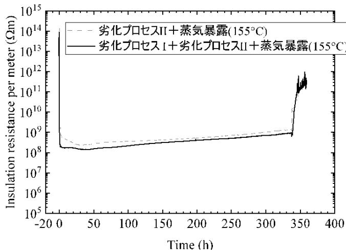
図2 国内のPWRで用いられている難燃エチレンプロピレンジエンゴム絶縁ケーブルの蒸気暴露中のケーブル長さ1m当たりの絶縁抵抗の変化<sup>[4]</sup>
