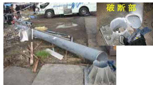
倒壊した道路標識支柱
