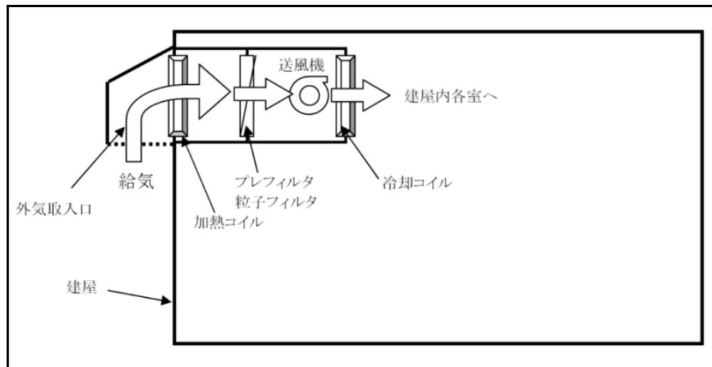
第1図 建屋換気設備外気取入口概要図
