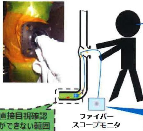
弁箱内部に使用する機材に異物の付着がないことを確実に確認する。
