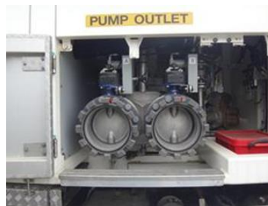
大型移送ポンプ車吐出部 可搬型建屋外ホース接続箇所 (300A)
