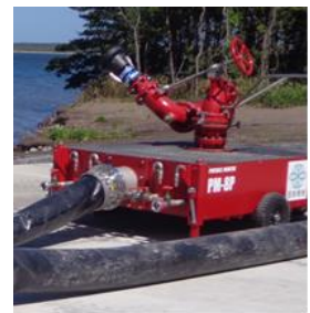
可搬型放水砲後部 可搬型建屋外ホース接続箇所 (300 A)
