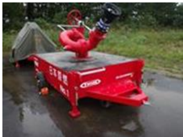
可搬型放水砲
