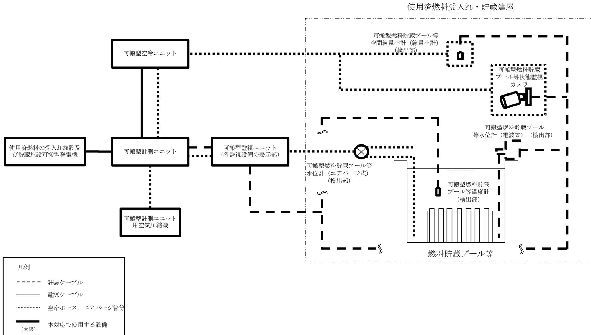
第5-15図 燃料貯蔵プール等の状況監視 系統概要図
