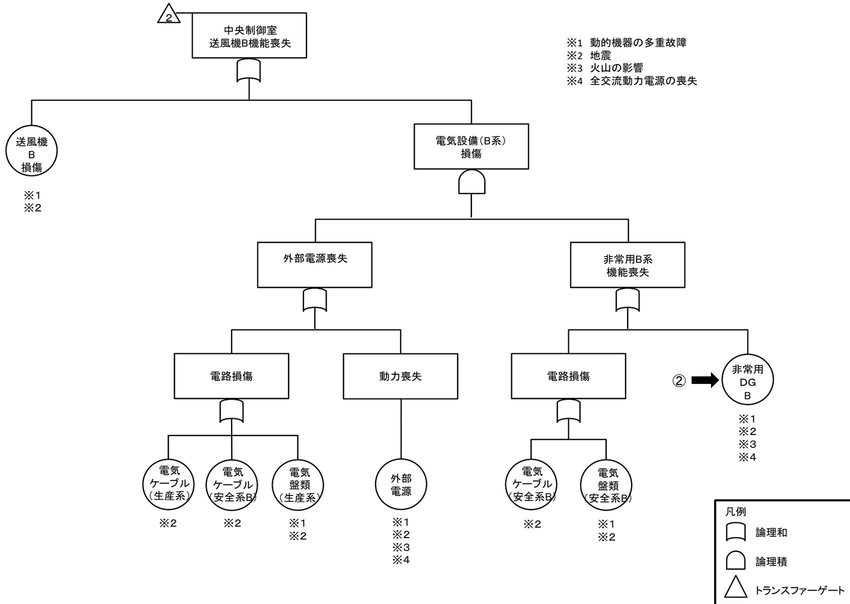
第10-1図 中央制御室の居住性確保（換気）のための措置のフォールトツリー分析（4/435）
