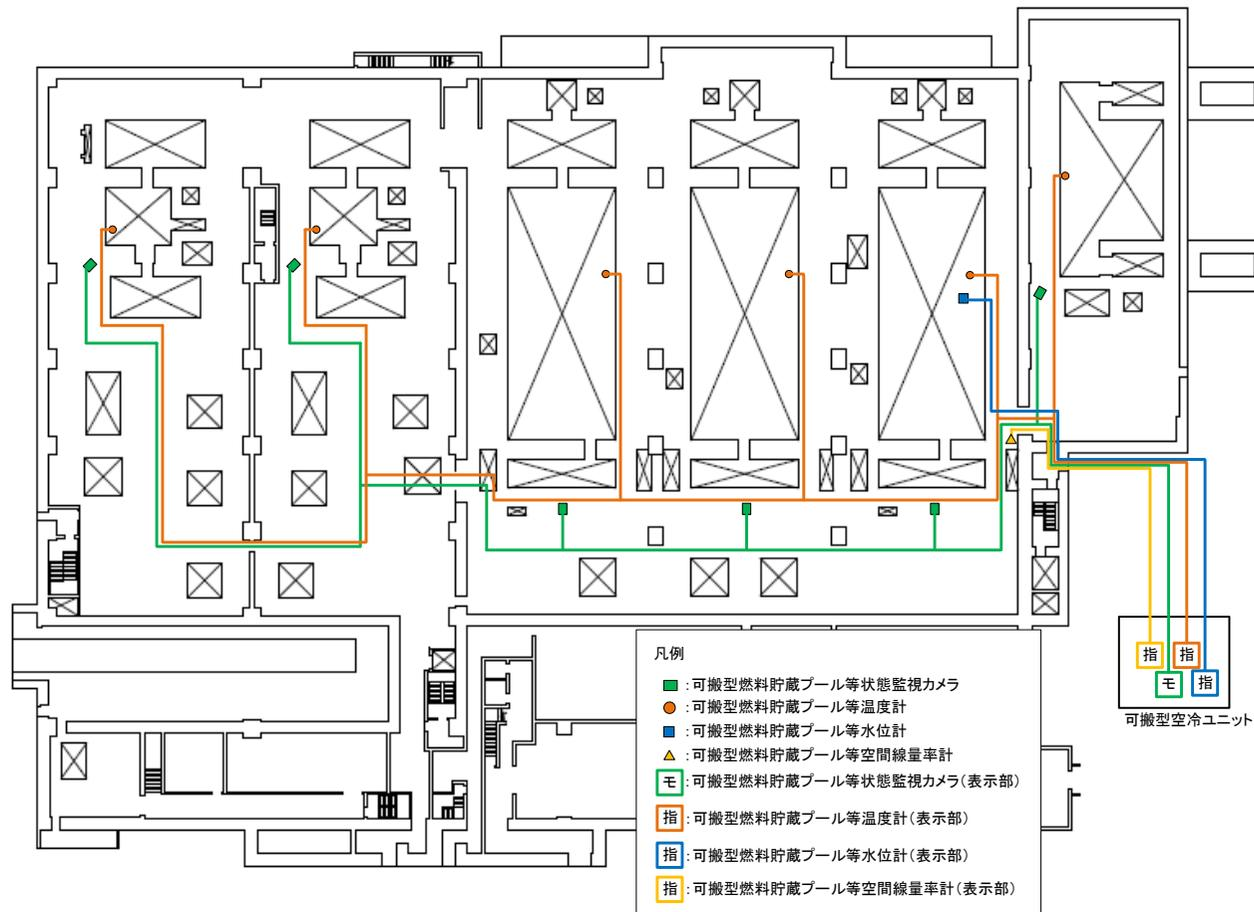
第5-18図 燃料貯蔵プール等の監視に用いる設備の使用済燃料受入れ・貯蔵建屋内配置図（南ルート）
