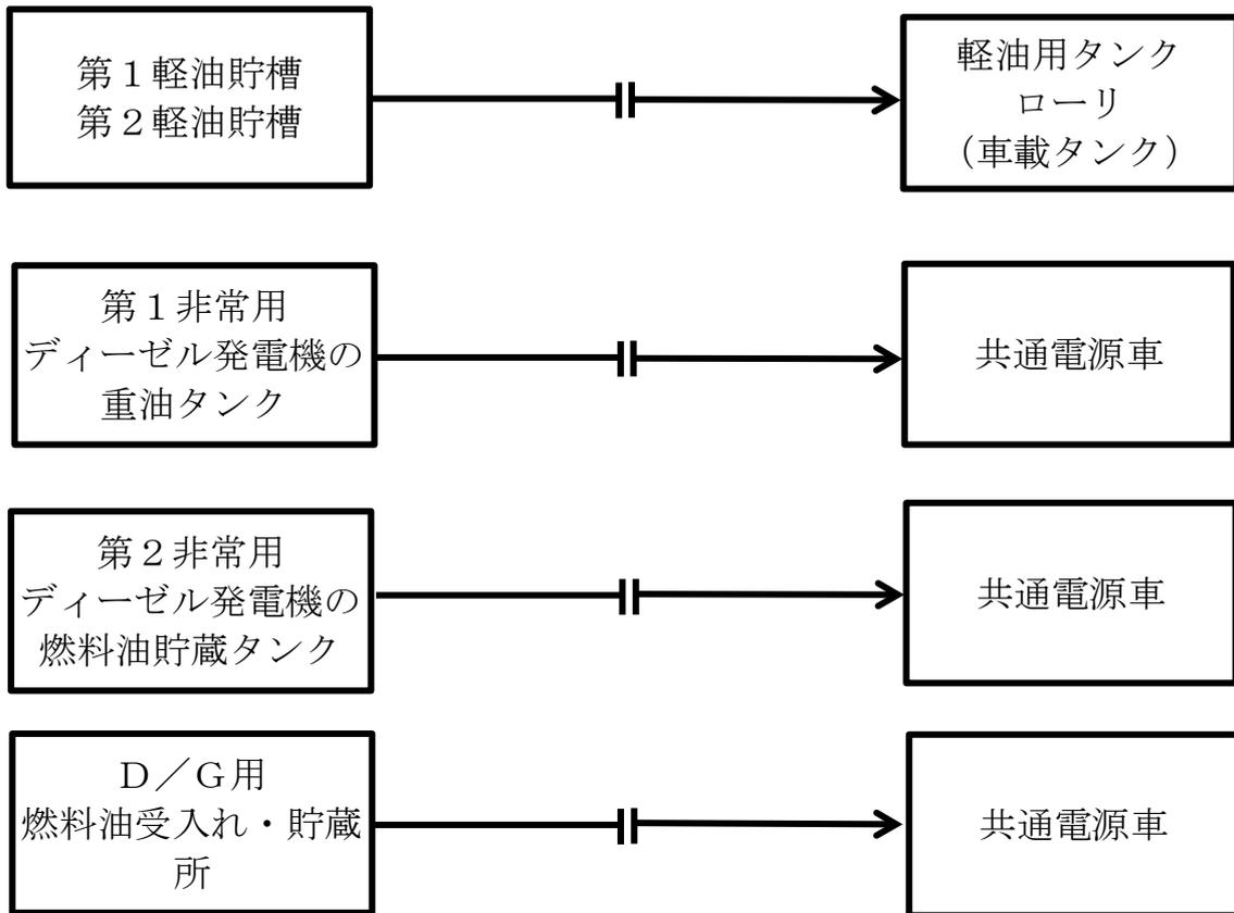
第8-15図 可搬型発電機及び共通電源車への補給の系統図 (2/2)
