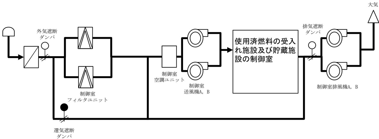
第10-20図 使用済燃料受入れ・貯蔵建屋制御室換気設備概要図
