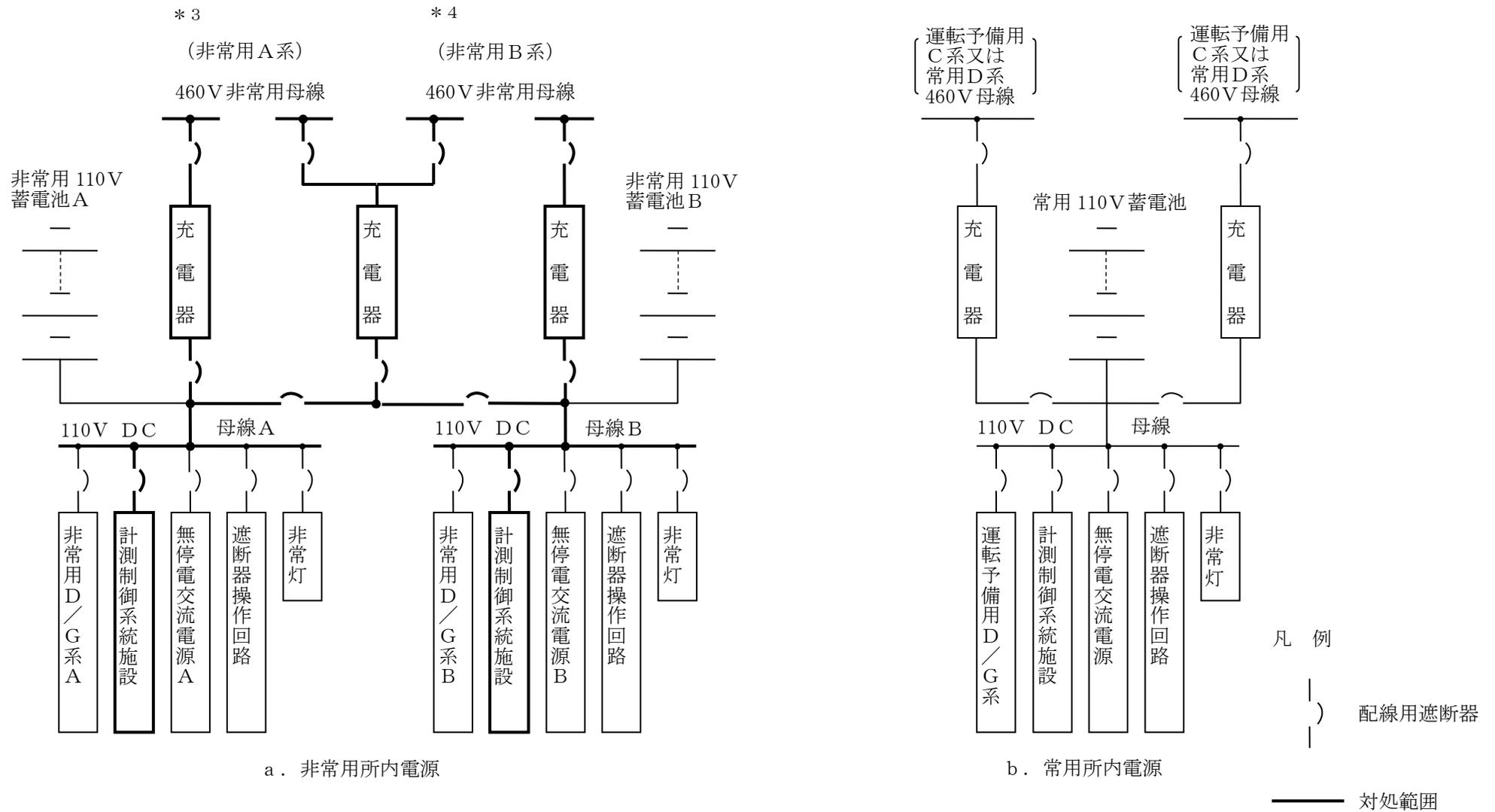
第 8 - 13 図 共通電源車による使用済燃料の受入れ施設及び貯蔵施設の 6.9 k V 非常用母線への給電の系統図 (3 / 3)
