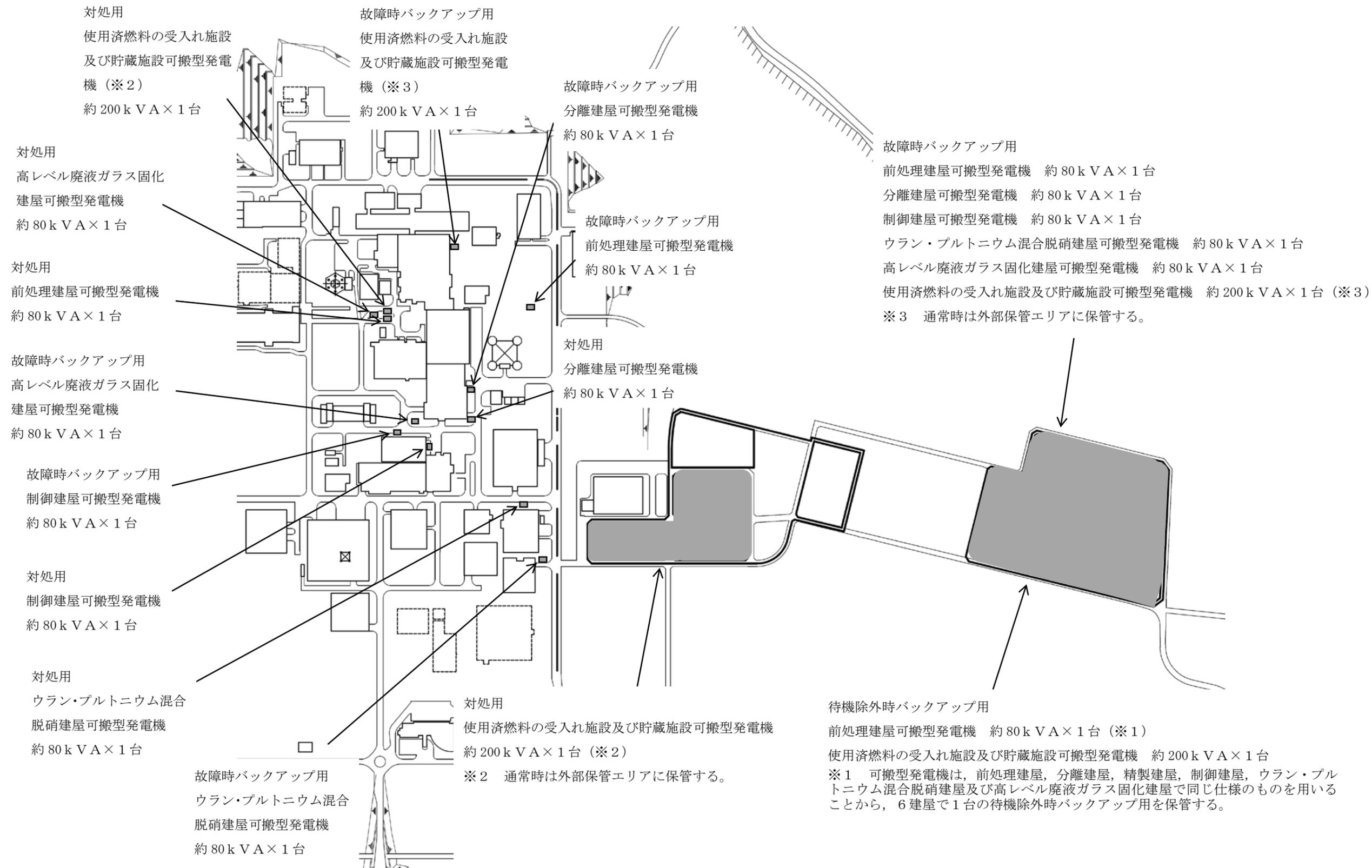
第8-2図 電源確保の機器配置概要図（重大事故等への対処に必要な可搬型発電機の配備計画と保管場所）
