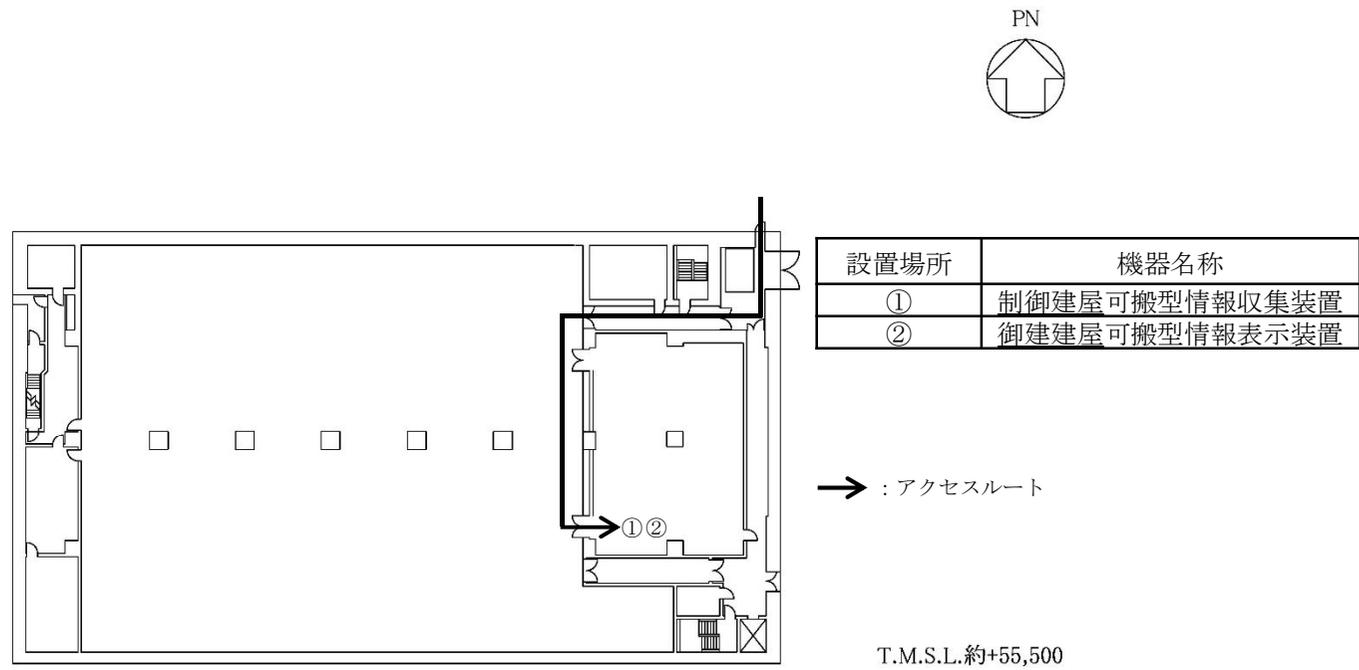
第9-27図 情報把握計装設備のアクセスルート図（制御建屋 地上1階）
