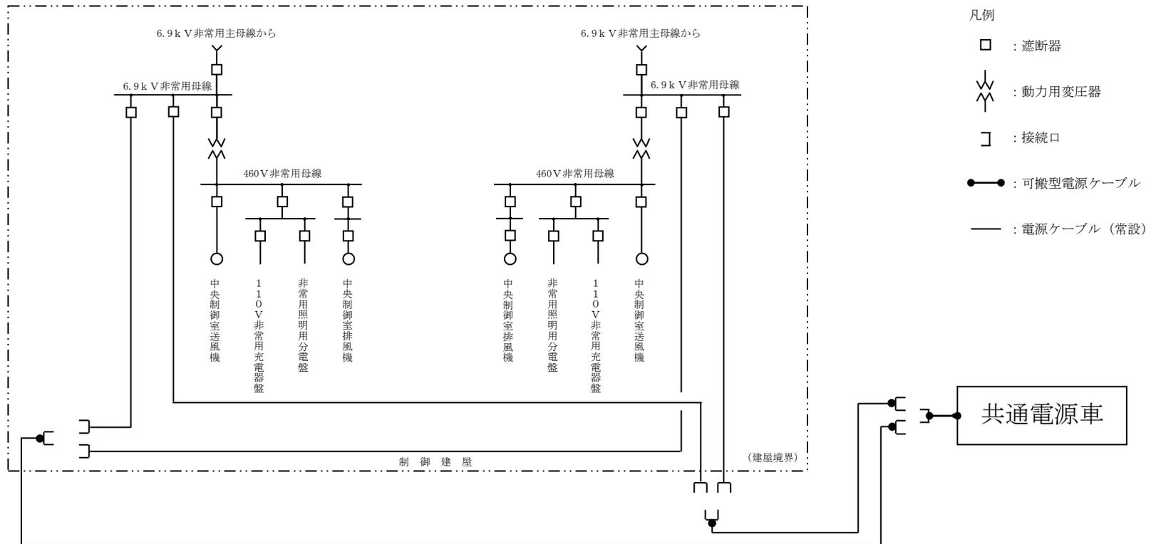
第 8 - 11 図 共通電源車による制御建屋の 6.9 k V 非常用母線への給電の系統図
