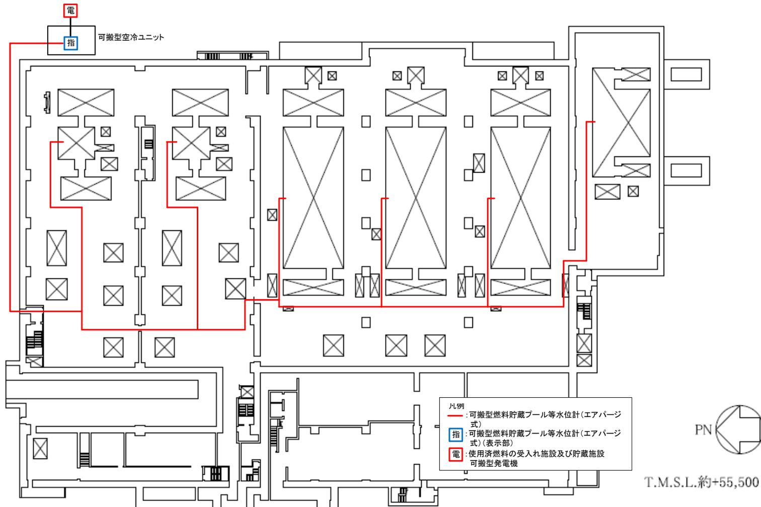
第5-19 図 燃料貯蔵プール等の監視に用いる設備の使用済燃料受入れ・貯蔵建屋内配置図(北ルート)
