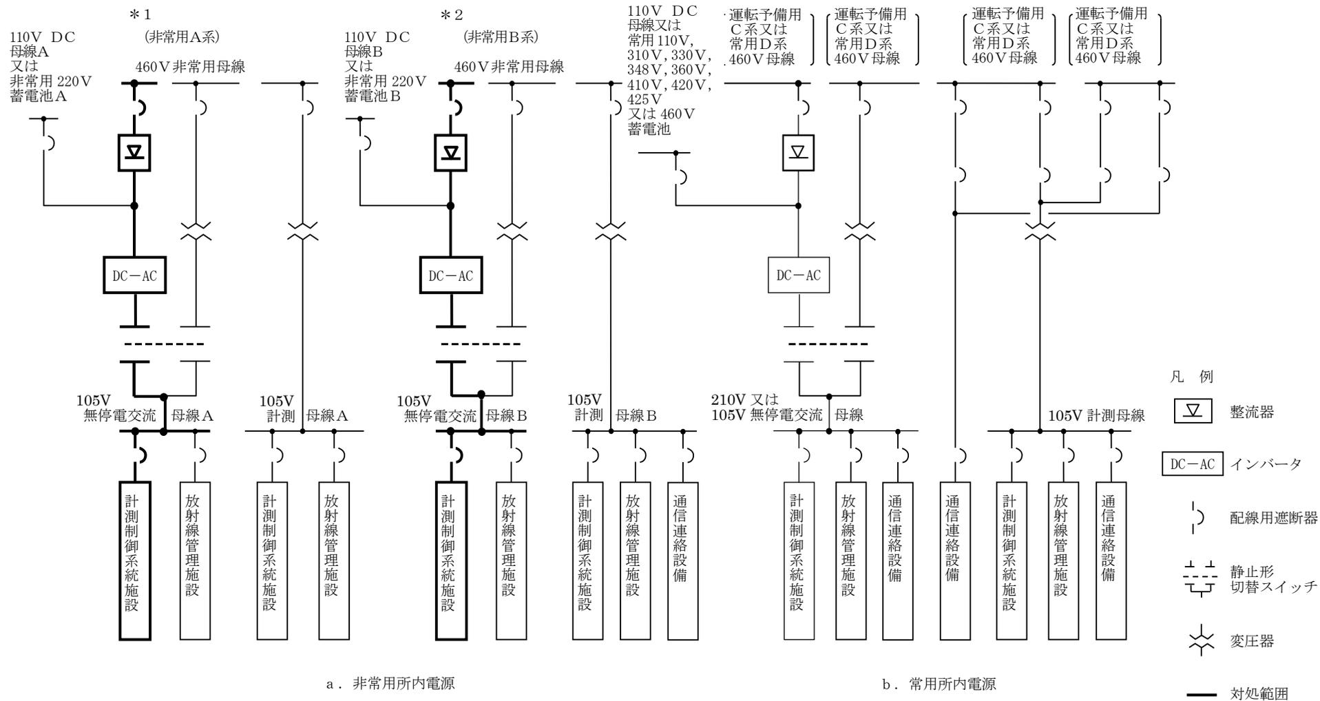
第 8 - 13 図 共通電源車による使用済燃料の受入れ施設及び貯蔵施設の 6.9 kV 非常用母線への給電の系統図 (2 / 3)
