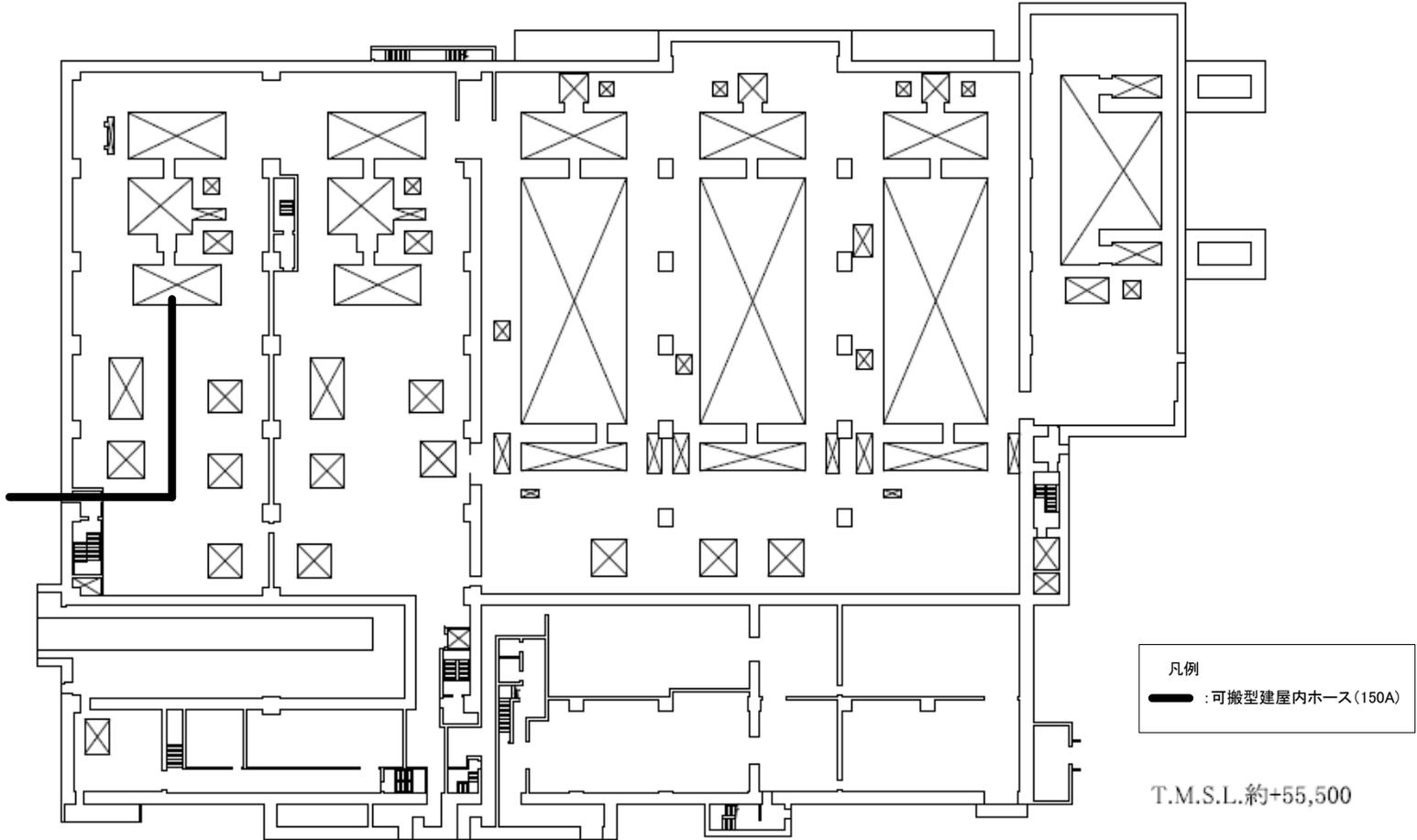
第5-6図 代替注水設備の使用済燃料受入れ・貯蔵建屋内配置図（南ルート）
