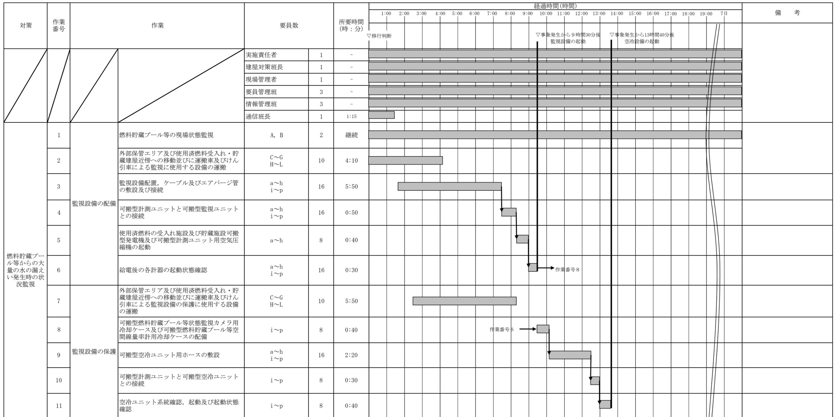
第5-16図 燃料貯蔵プール等からの大量の水の漏えい発生時の状況監視 タイムチャート
