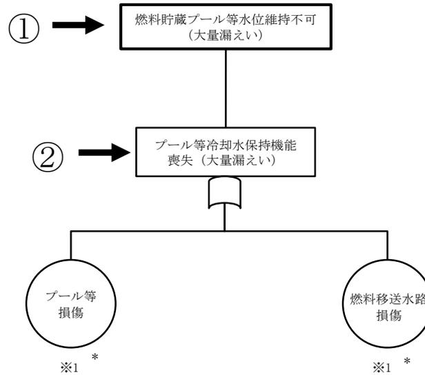
\* 基準地震動の1.2倍の地震動を考慮した際に機能維持できる設計としているが、地震による損傷により大量の水の漏えいを想定する。
