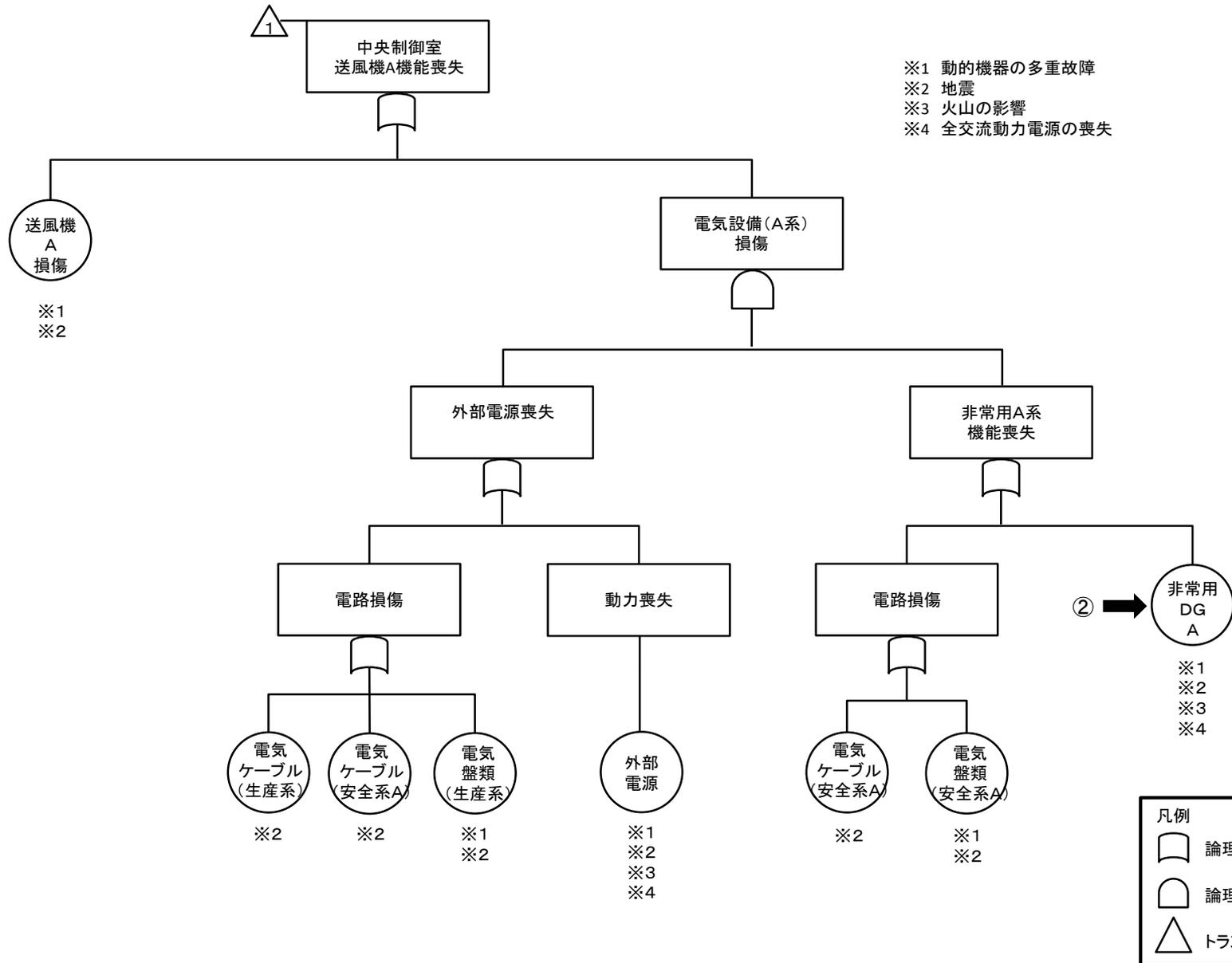
第10-1図 中央制御室の居住性確保（換気）のための措置のフォールトツリー分析（3/434）
