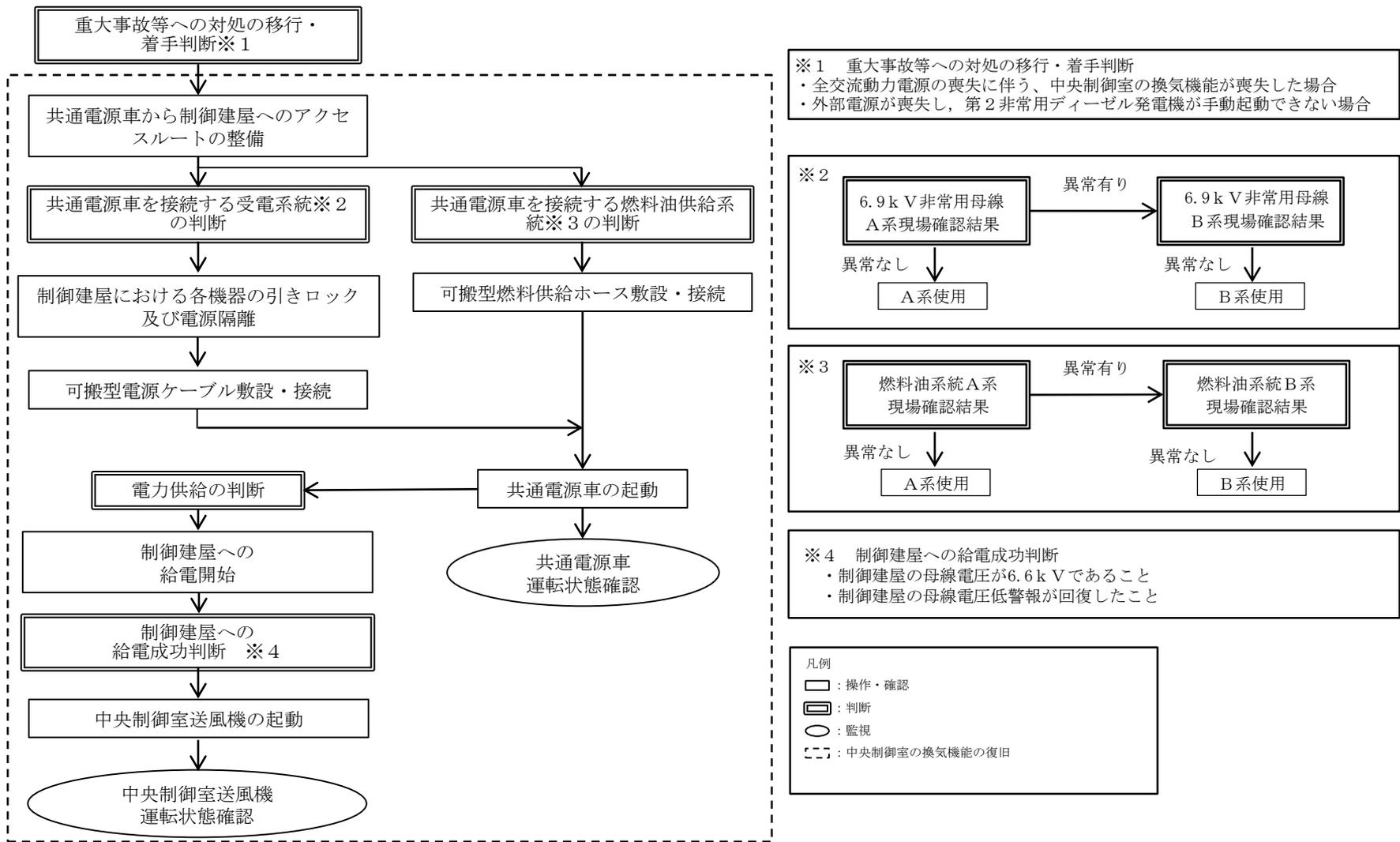
第10-16図 共通電源車を用いた中央制御室の換気機能の復旧手順の概要（制御建屋給電） 1461
