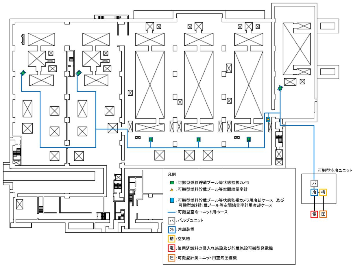
第5-22 図 燃料貯蔵プール等の監視に用いる設備の使用済燃料受入れ・貯蔵建屋内配置図（南ルート）
