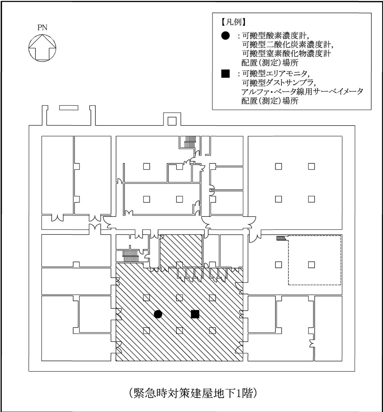
第 12-7 図 緊急時対策建屋環境測定設備,
