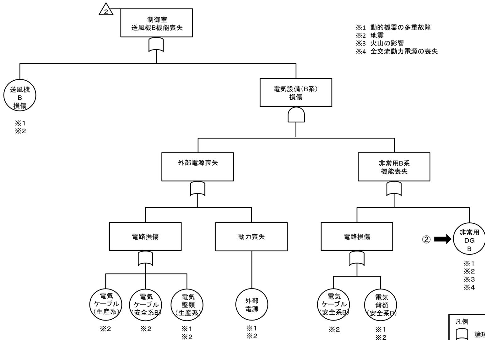
第10 - 2 図 使用済燃料の受け入れ施設及び貯蔵施設の制御室の居住性確保（換気）のための措置のフォールトツリー分析（4 / 4）
