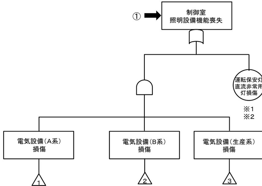
運転保安灯の内蓄電池内蔵型照明及び直流非常用灯は、蓄電池に接続されていることから電源喪失により、直ちに消灯しないが電気設備(A系、B系、生産系)の損傷と判断した時点で照明設備機能喪失と判断する。
