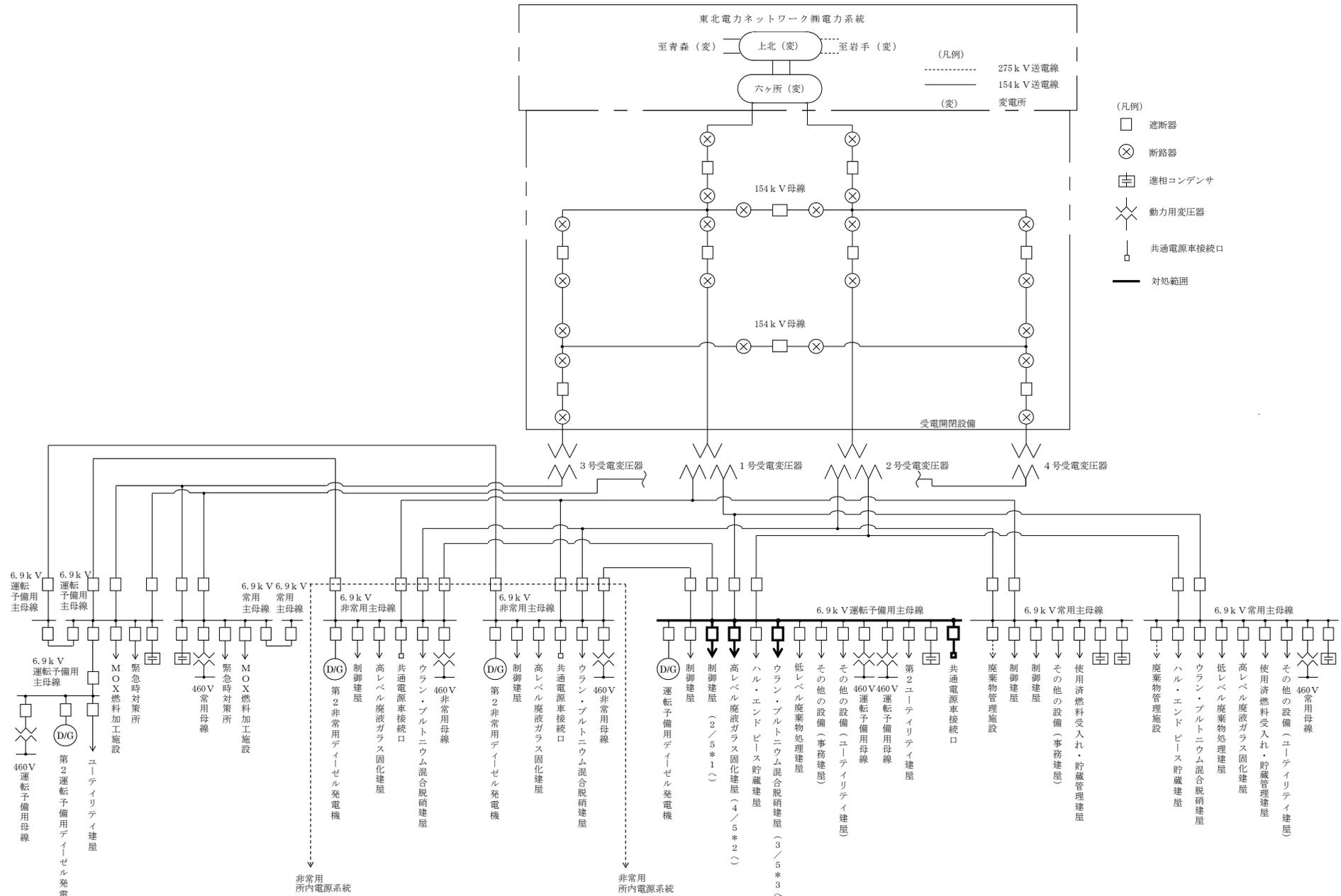
第8-12図 共通電源車によるユーティリティ建屋<sup>124</sup>の6.9 k V運轉予備用主母線への給電の系統図(1 / 5)
