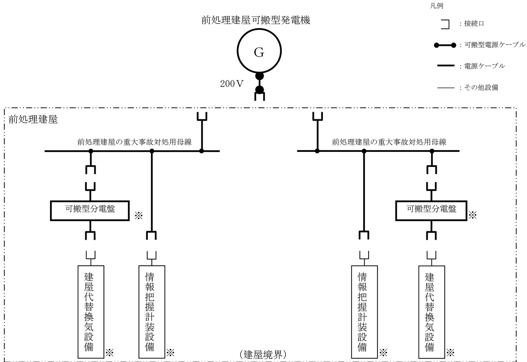
※前処理建屋の重大事故対処用母線 2 系統のうち、何れか 1 系統を選択して接続する。
