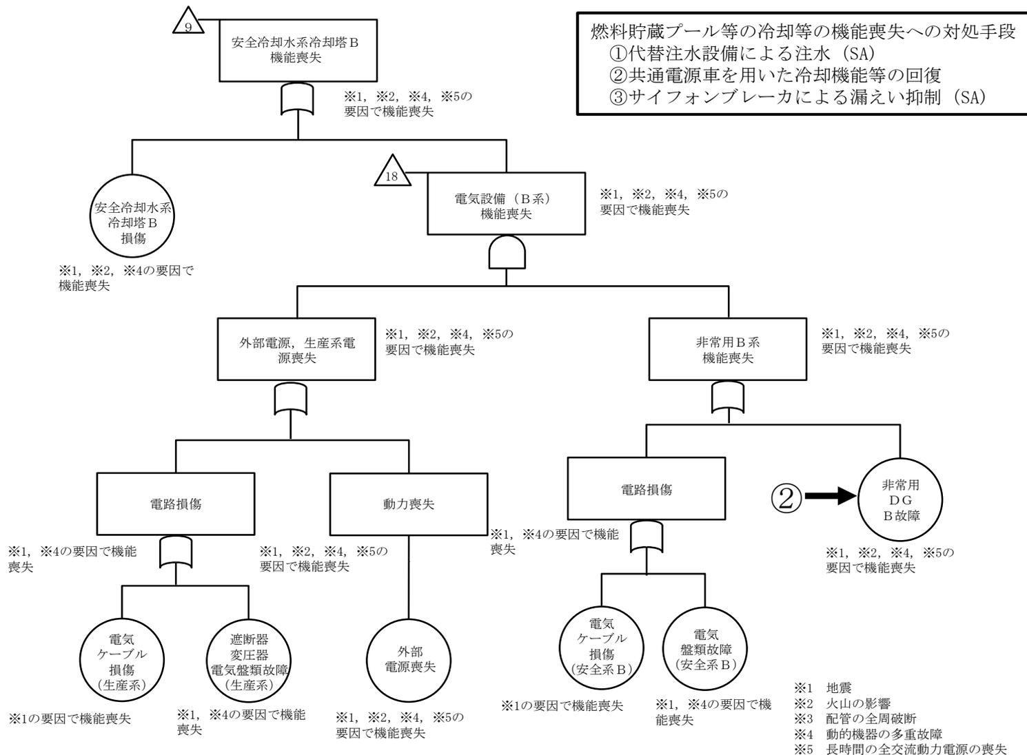
第5-1図(1) 想定事故1及び想定事故2の燃料損傷防止対策の
