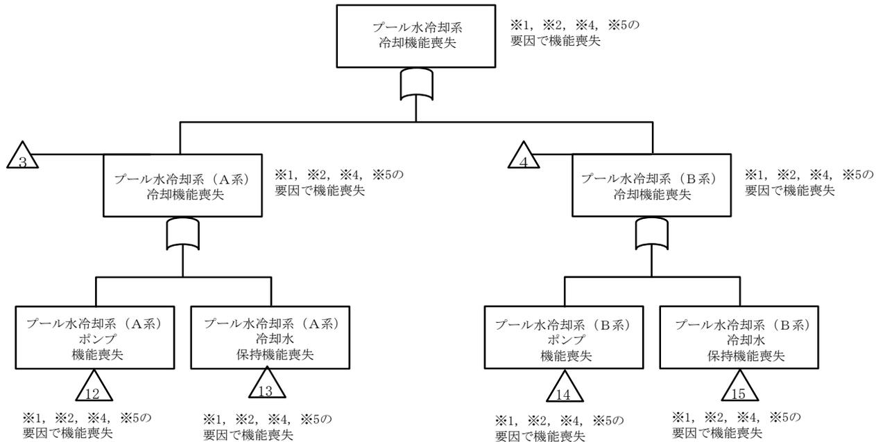
第5-1図(1) 想定事故1及び想定事故2の燃料損傷防止対策の
