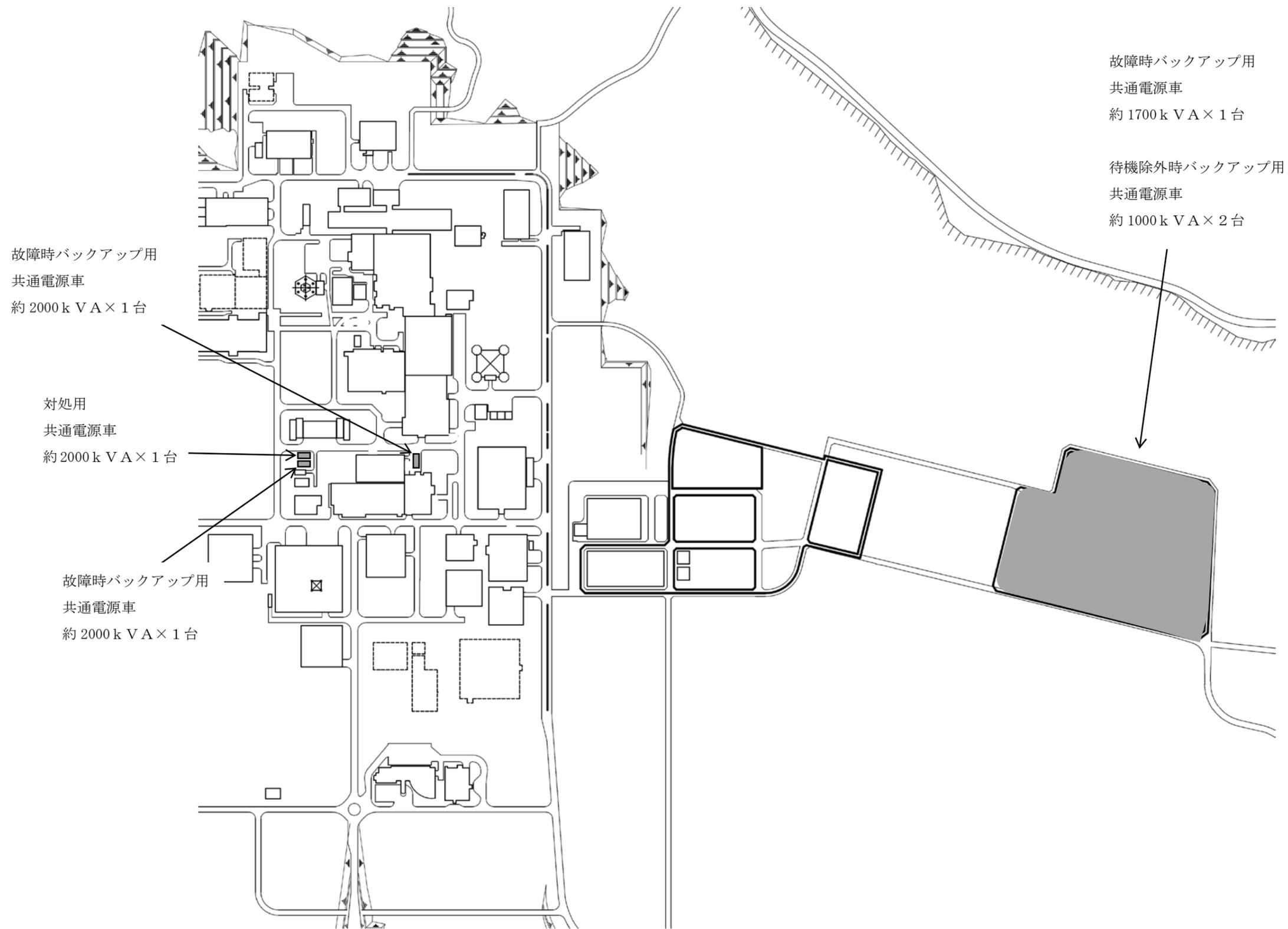
第 8 - 14 図 共通電源車の機器配置概要図
