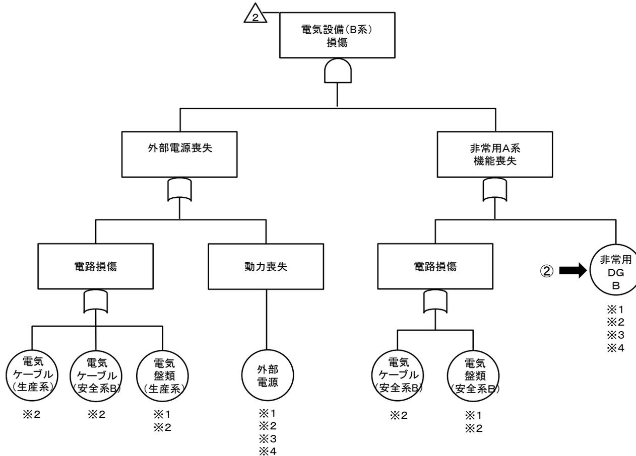
第10 - 4 図 使用済燃料の受け入れ施設及び貯蔵施設の制御室の居住性確保（照明）のための措置のフォールトツリー分析（4 / 5）
