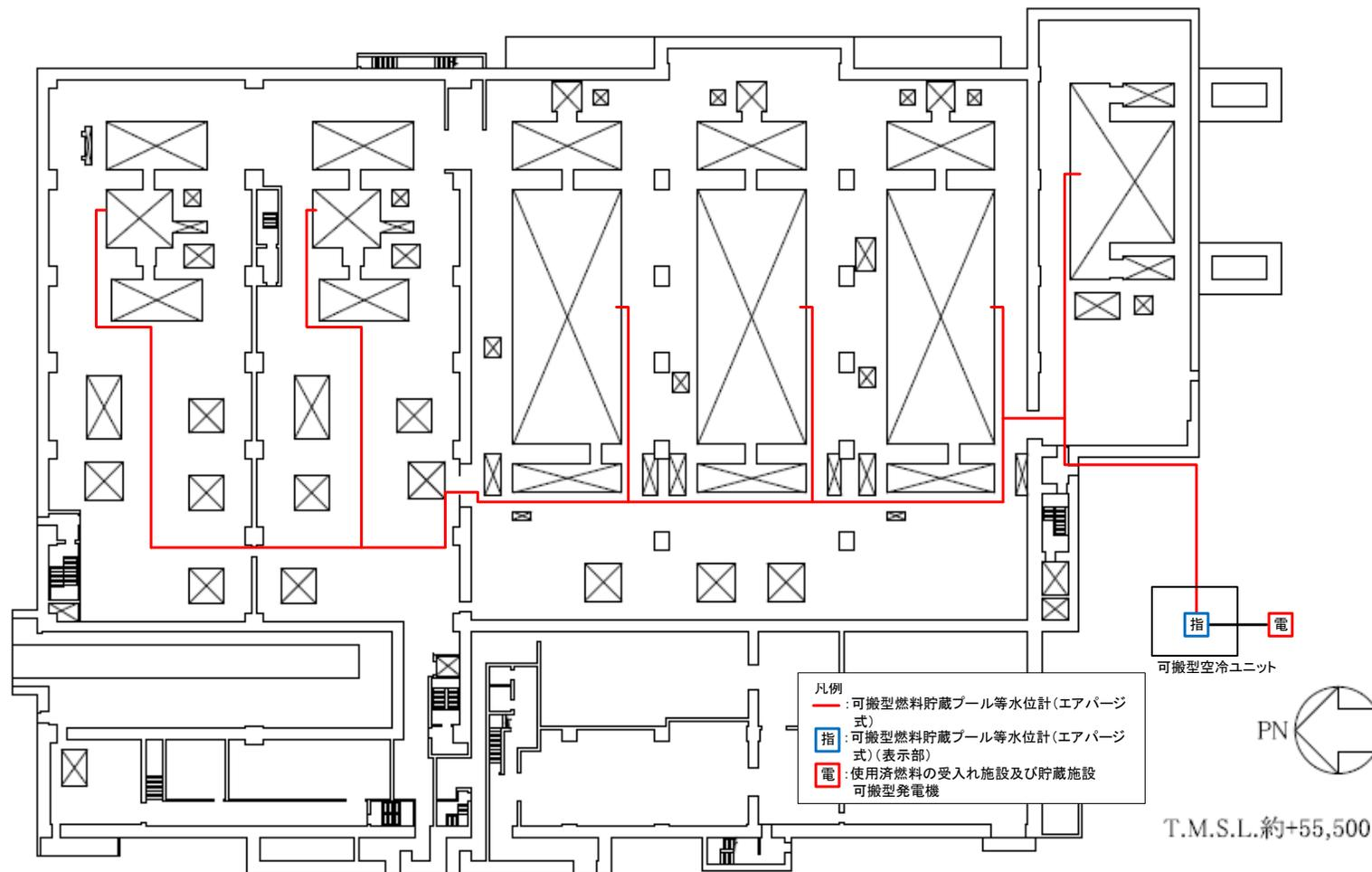
第5-20 図 燃料貯蔵プール等の監視に用いる設備の使用済燃料受入れ・貯蔵建屋内配置図 (南ルート)
