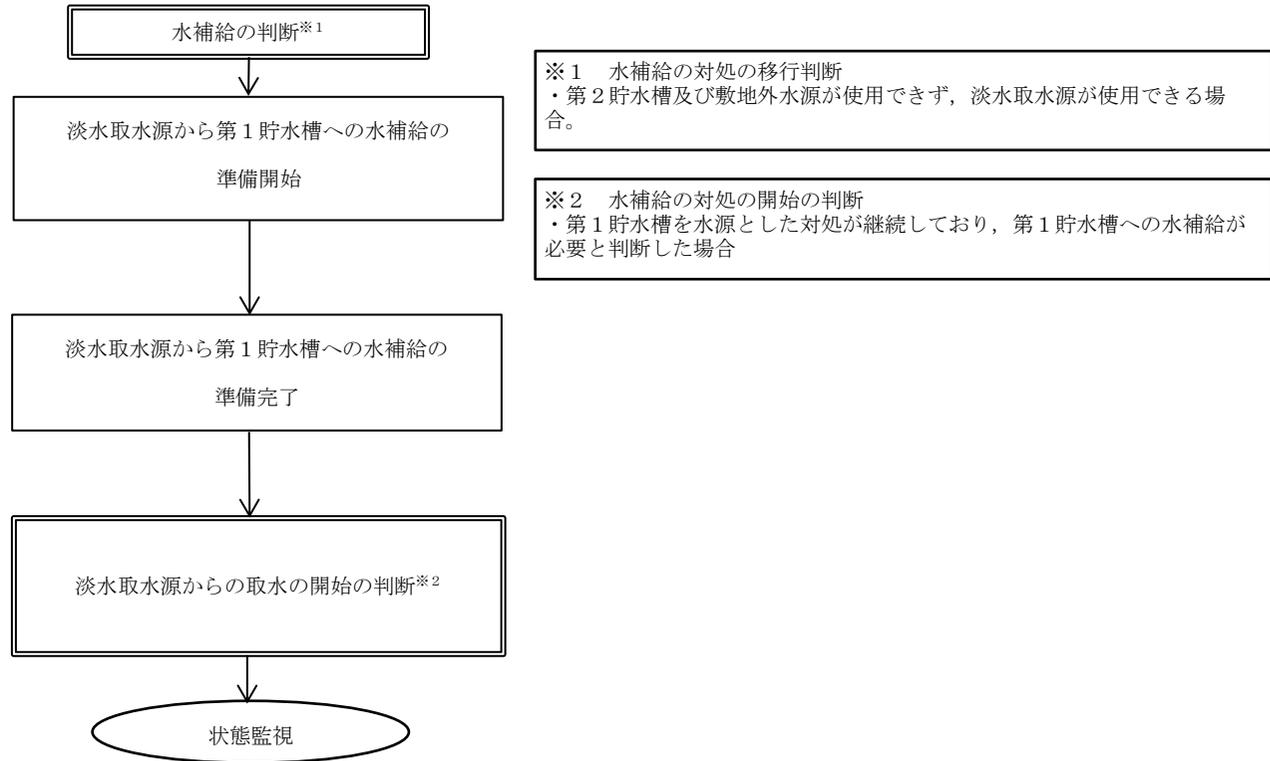
第7-16図 「淡水取水源を水源とした第1貯水槽への水の補給」の手順の対応フロー
