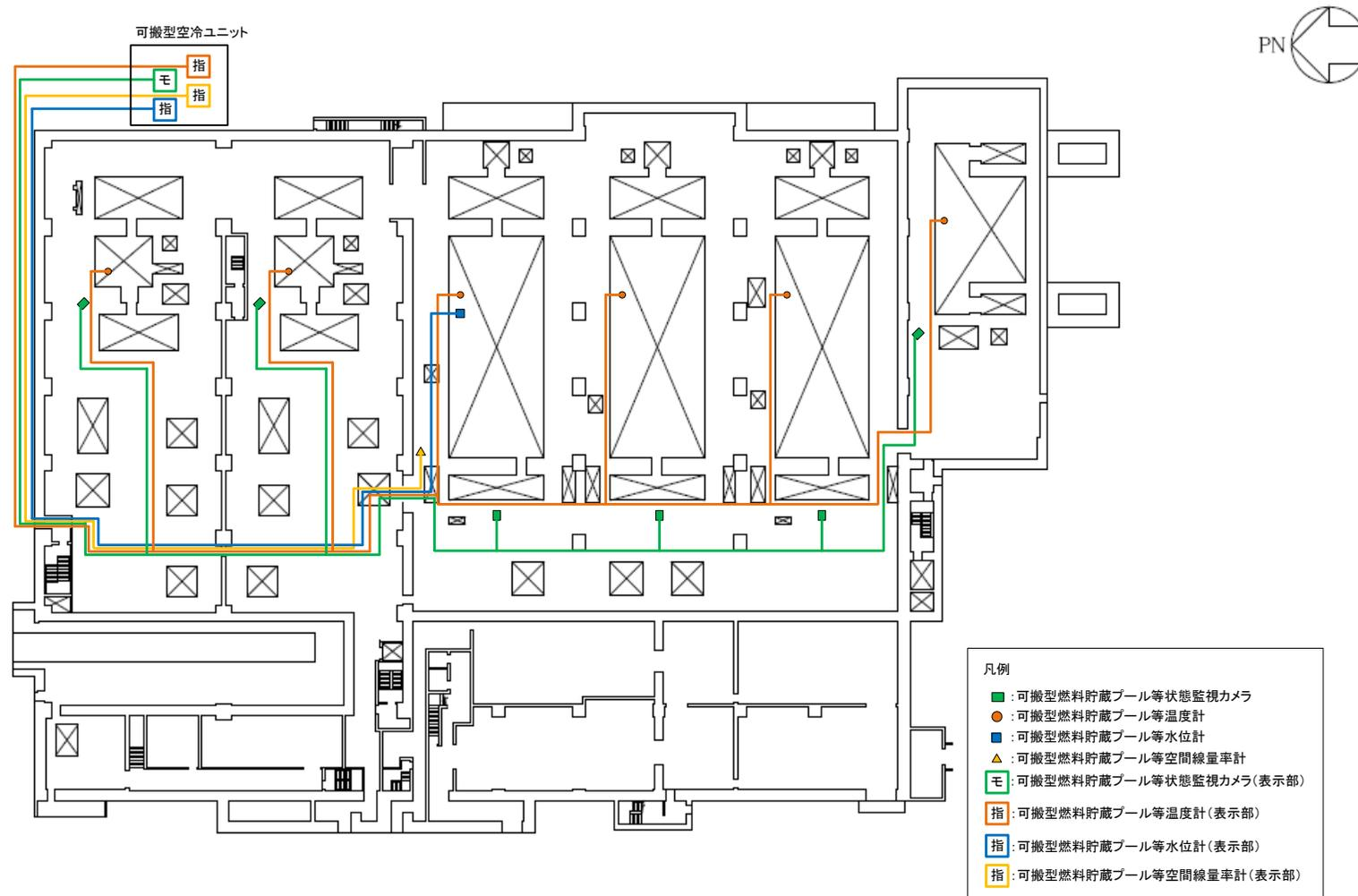
第5-17図 燃料貯蔵プール等の監視に用いる設備の使用済燃料受入れ・貯蔵建屋内配置図（北ルート）
