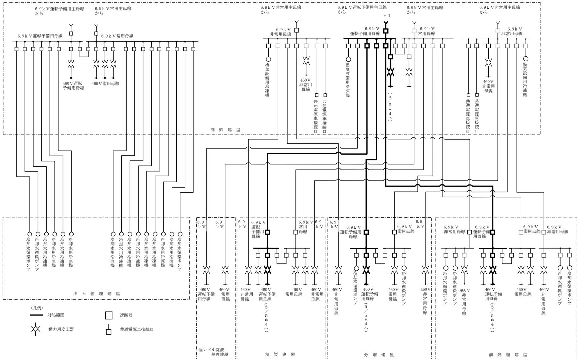
第8-12図 共通電源車によるユーティリティ建屋の6.9kV運転予備用主母線への給電の系統図(2/5) 1132
