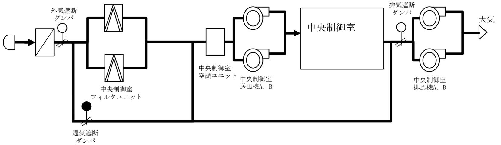
第10-17図 制御建屋中央制御室換気設備概要図
