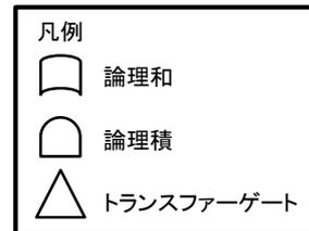
第10 - 4 図 使用済燃料の受け入れ施設及び貯蔵施設の制御室の居住性確保（照明）のための措置のフォールトツリー分析（5 / 5）
