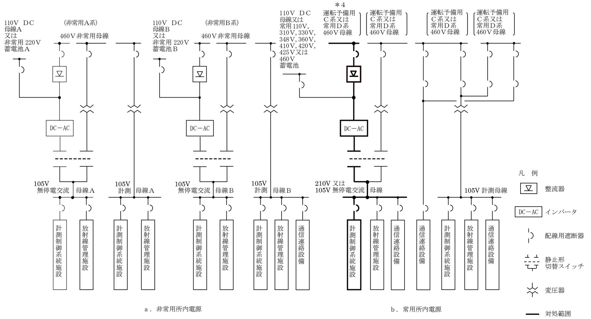
第8-12図 共通電源車によるユーティリティ建屋の6.9kV運転予備用主母線への給電の系統図(5/5)
