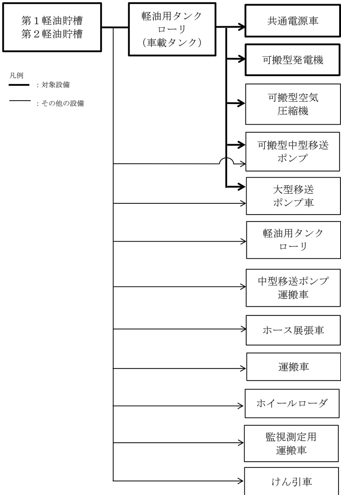
第8-15図 可搬型発電機及び共通電源車への補給の系統図 (1/2)
