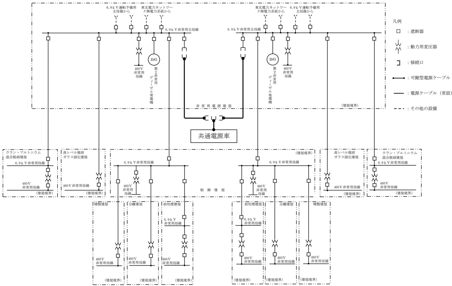
第8-10図 共通電源車による非常用電源建屋の6.9 kV非常用主母線への給電の系統図
