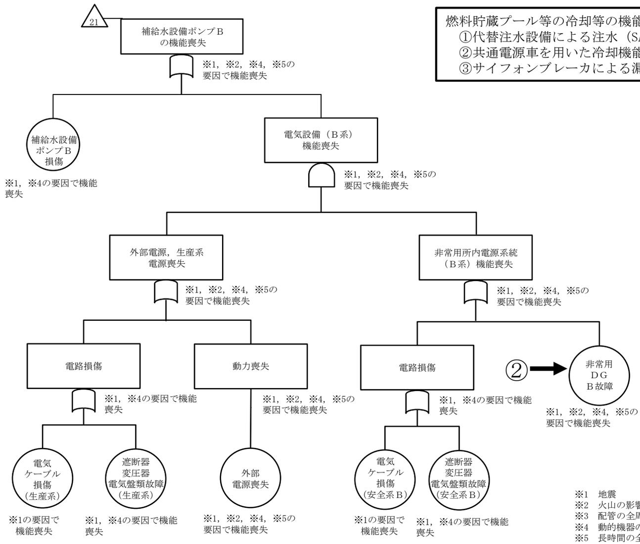
第5-1図(1) 想定事故1及び想定事故2の燃料損傷防止対策の
