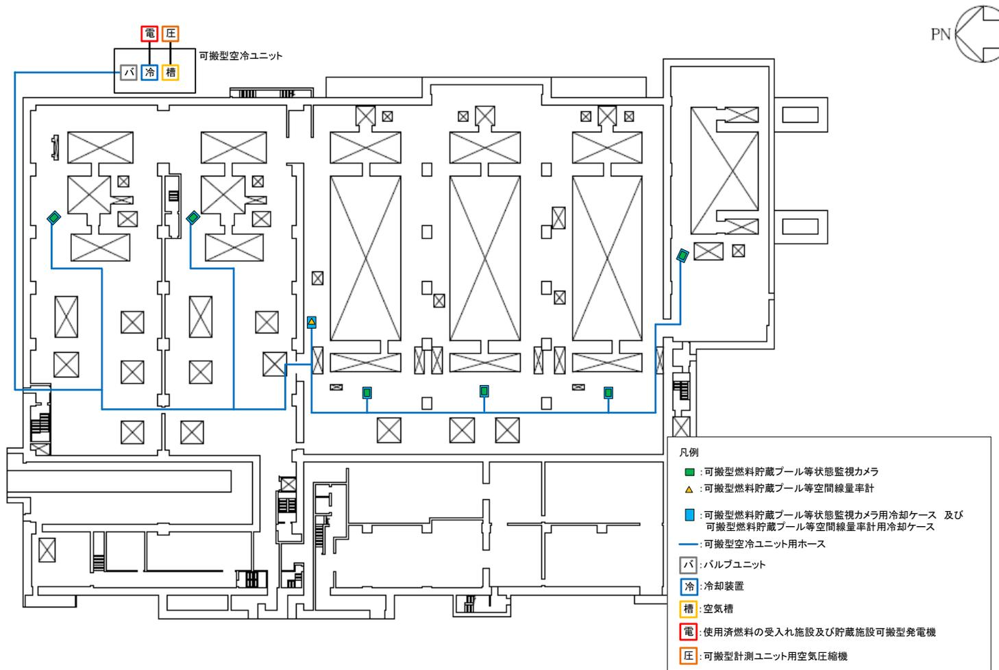
第5-21 図 燃料貯蔵プール等の監視に用いる設備の使用済燃料受入れ・貯蔵建屋内配置図（北ルート）
