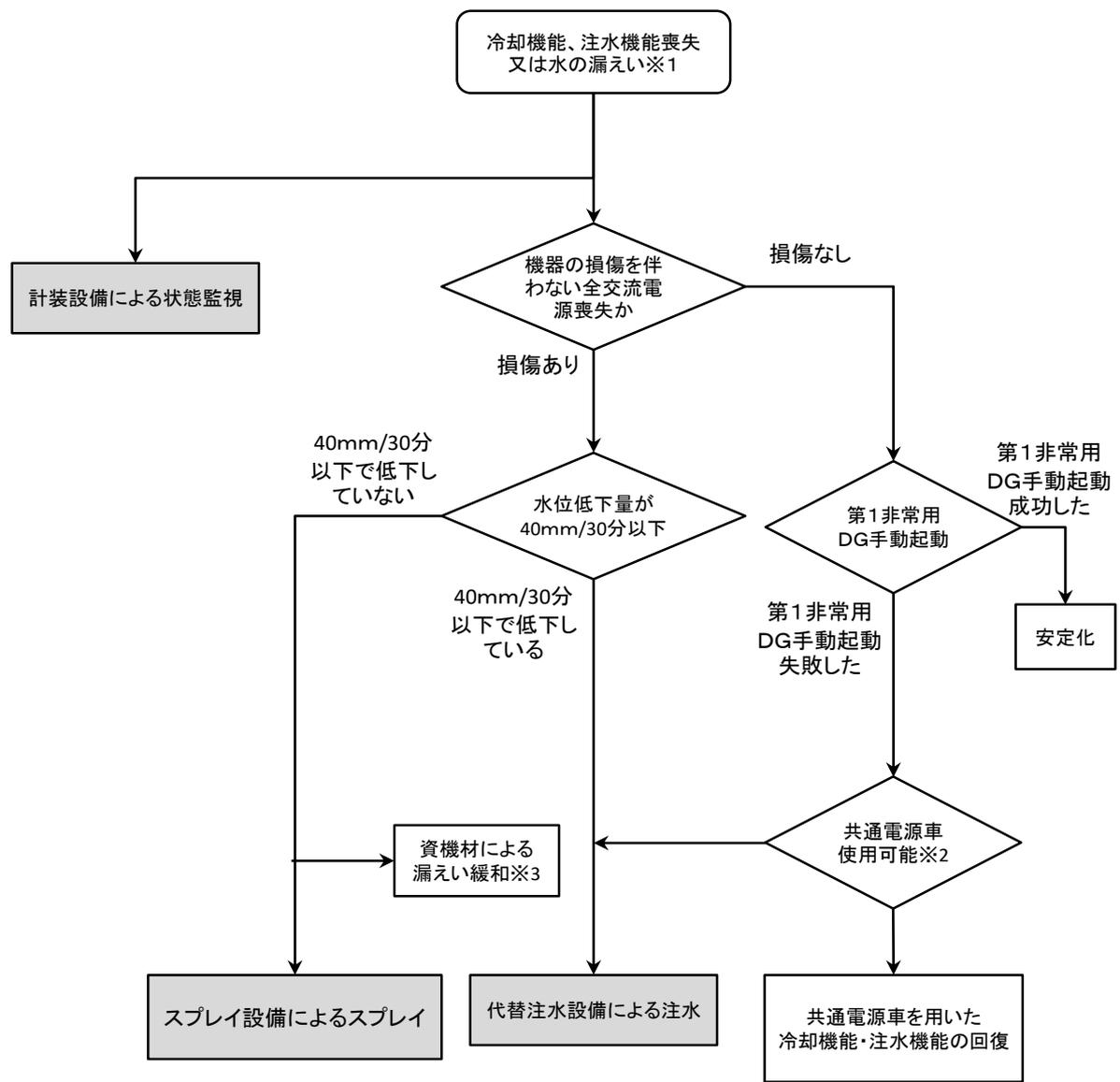
※1: 以下のいずれかによりプール水冷却系及び安全冷却水系の冷却機能の喪失並びに補給水設備等の注水機能が喪失した場合、若しくはそのおそれがある場合、又は燃料貯蔵プール等からの水の漏えいその他の要因により燃料貯蔵プール等の水位が低下した場合。
