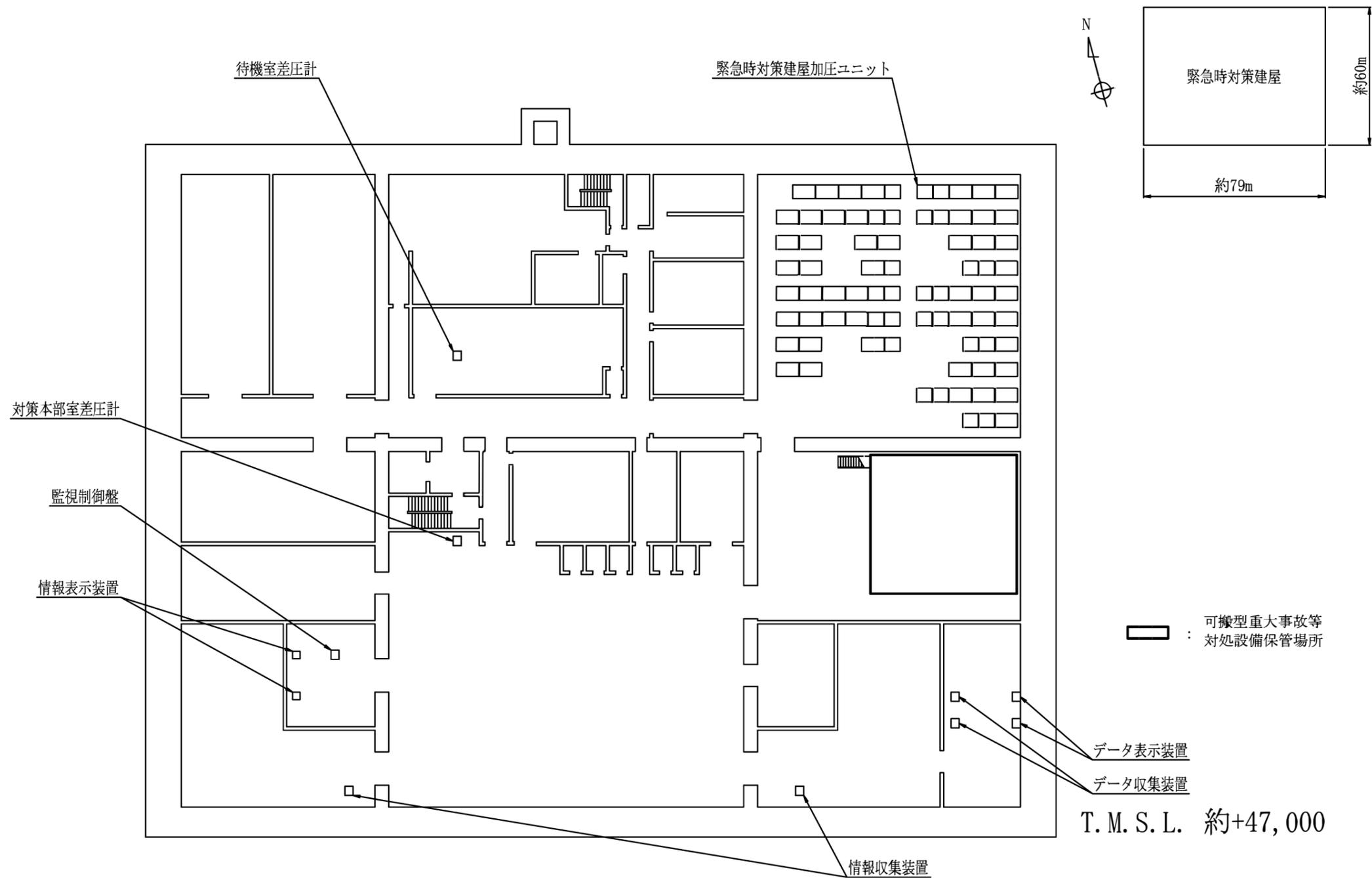
第9.16-2図 緊急時対策建屋機器配置概要図（地下1階）
