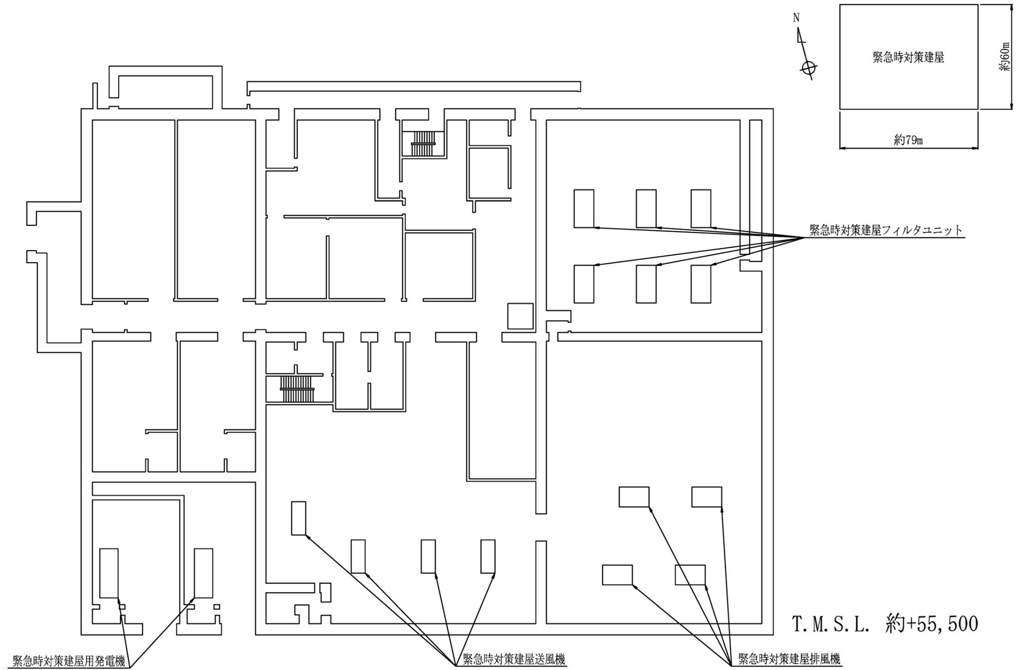
第9.16-3図 緊急時対策建屋機器配置概要図（地上1階）
