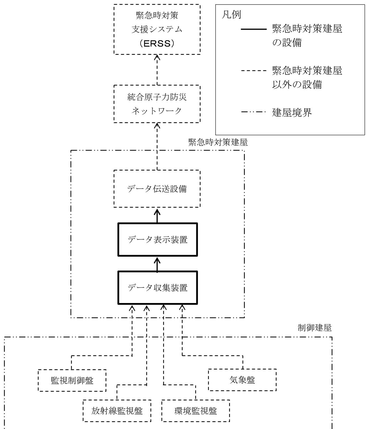
第 9.16-6 図 データ収集装置及びデータ表示装置の系統概要図
