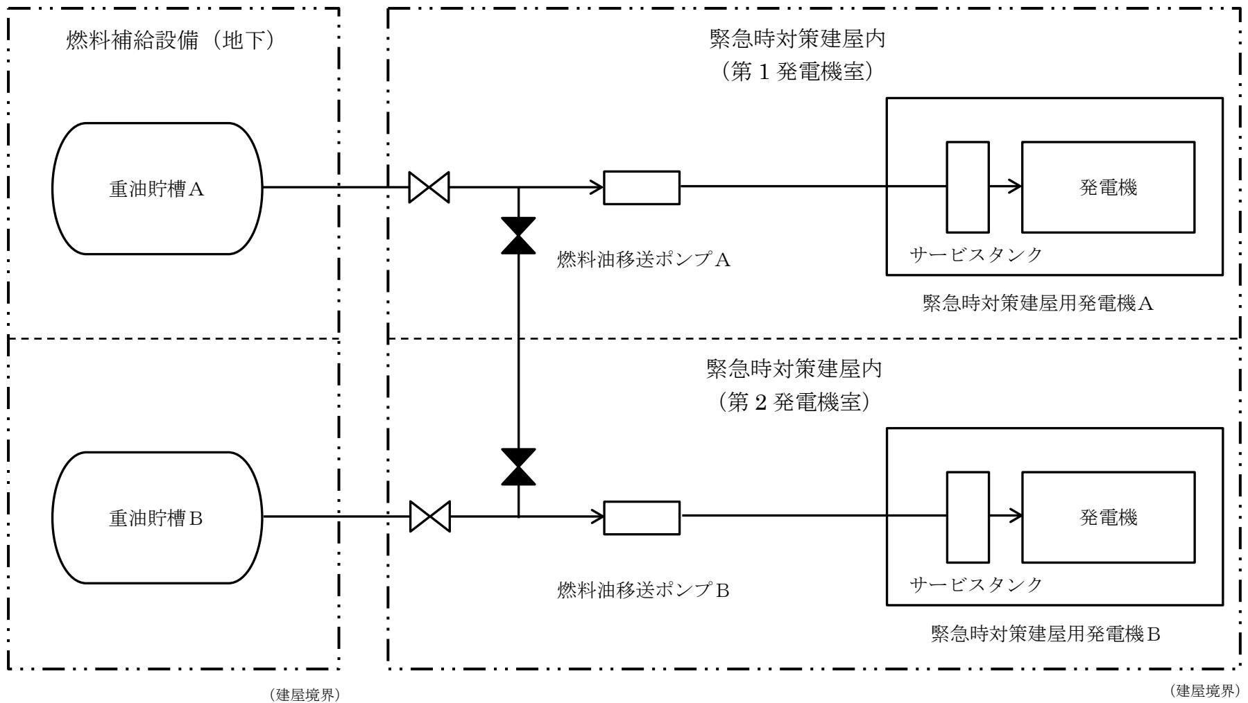
第 9.16-8 図 燃料補給設備の系統概要図
