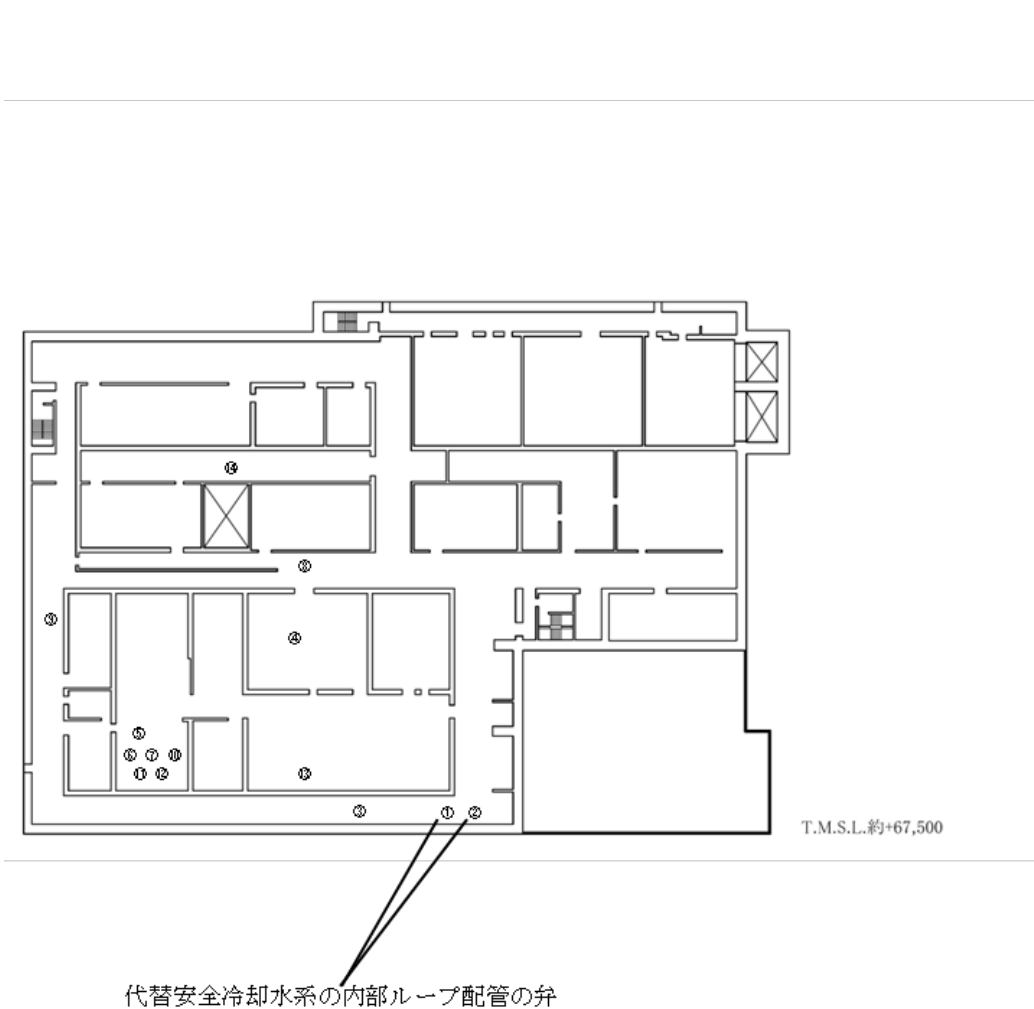
第 9.5-8 図(13) 蒸発乾固の発生防止対策 (内部ループへの通水による冷却) の機器及び接続口配置概要図 分離建屋 (地上3階)
