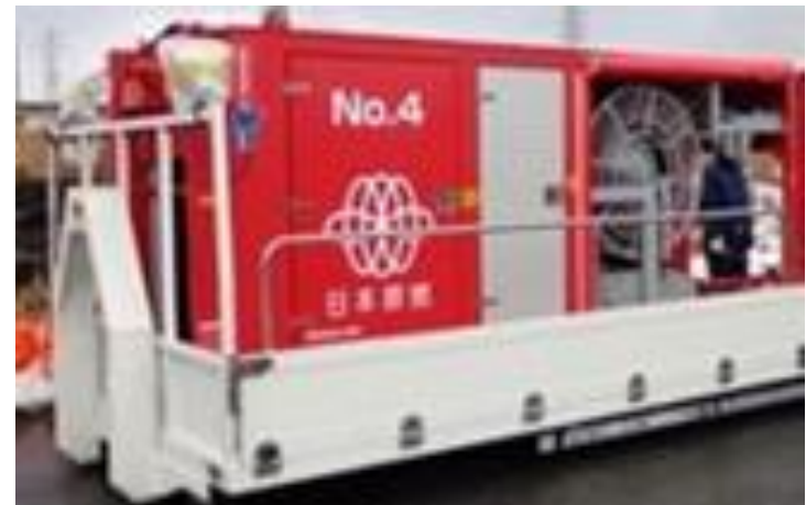
可搬型発電機
