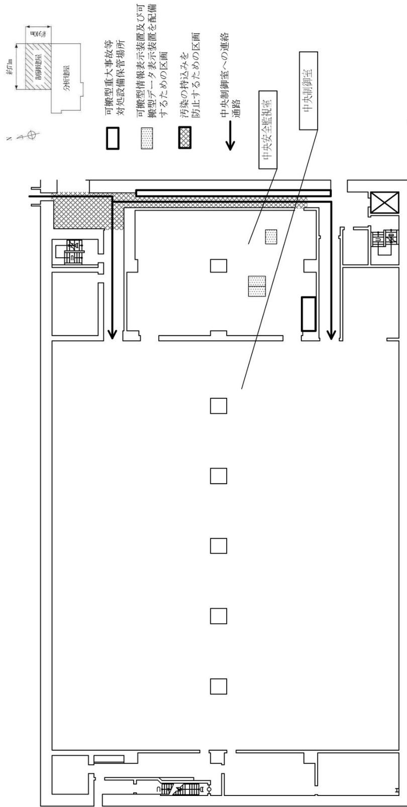
第 6.2.5-1 図 中央制御室の外から中央制御室に連絡する通路上の出入管理区画配置概要図
