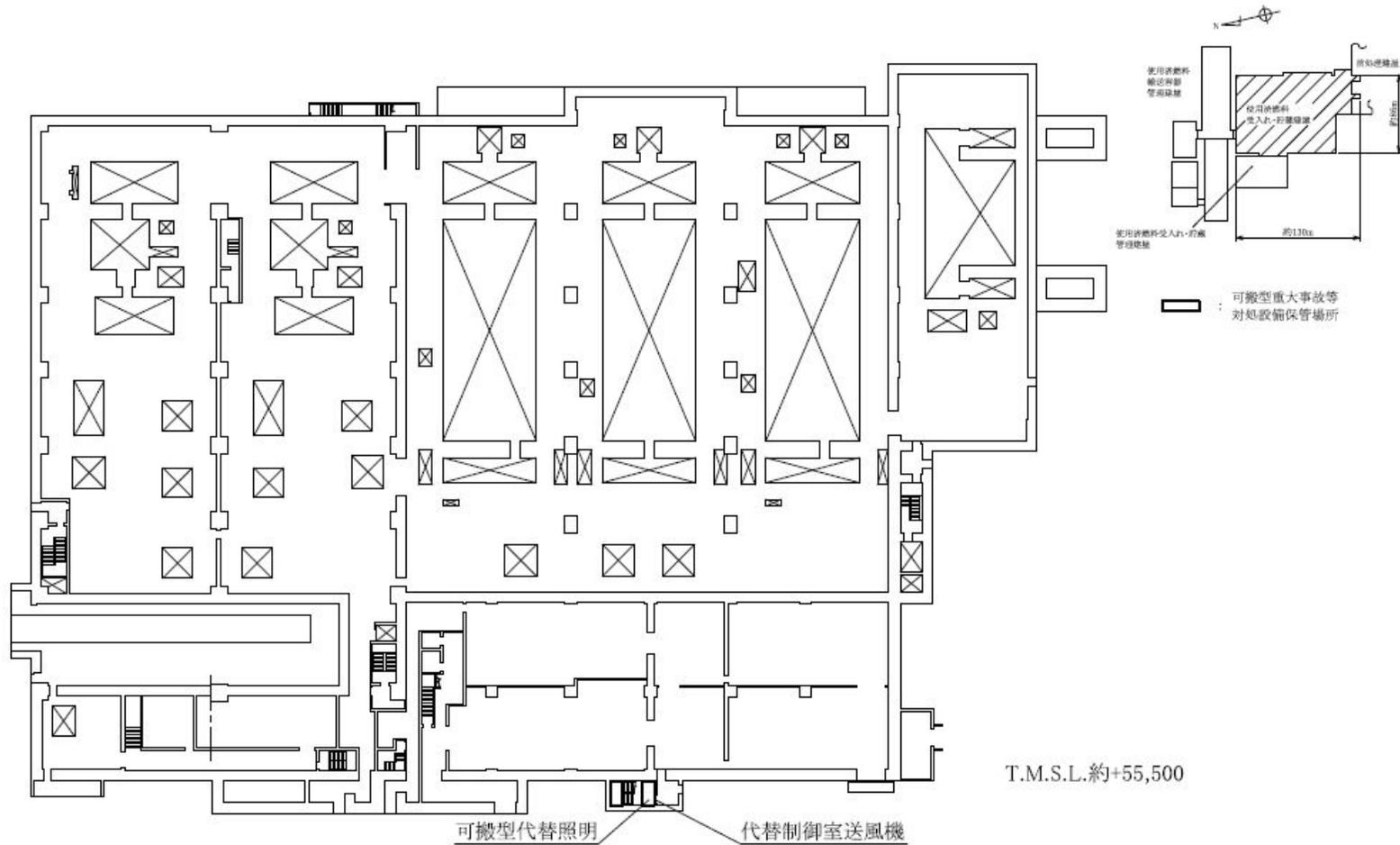
第6.2.5-14図 使用済燃料の受入れ施設及び貯蔵施設の重大事故等対処設備の機器配置概要図
