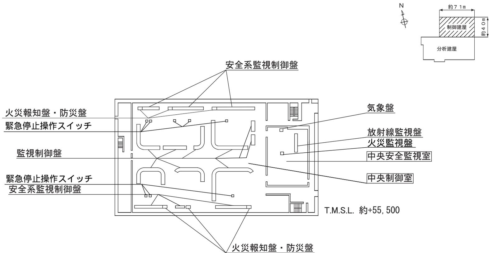
第168図 制御建屋機器配置概要図（地上1階）
