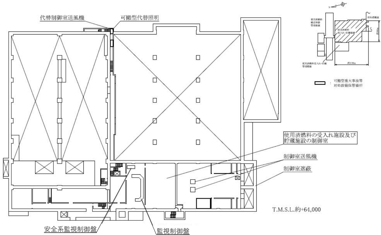
第6.2.5-15図 使用済燃料の受入れ施設及び貯蔵施設の重大事故等対処設備の機器配置概要図
