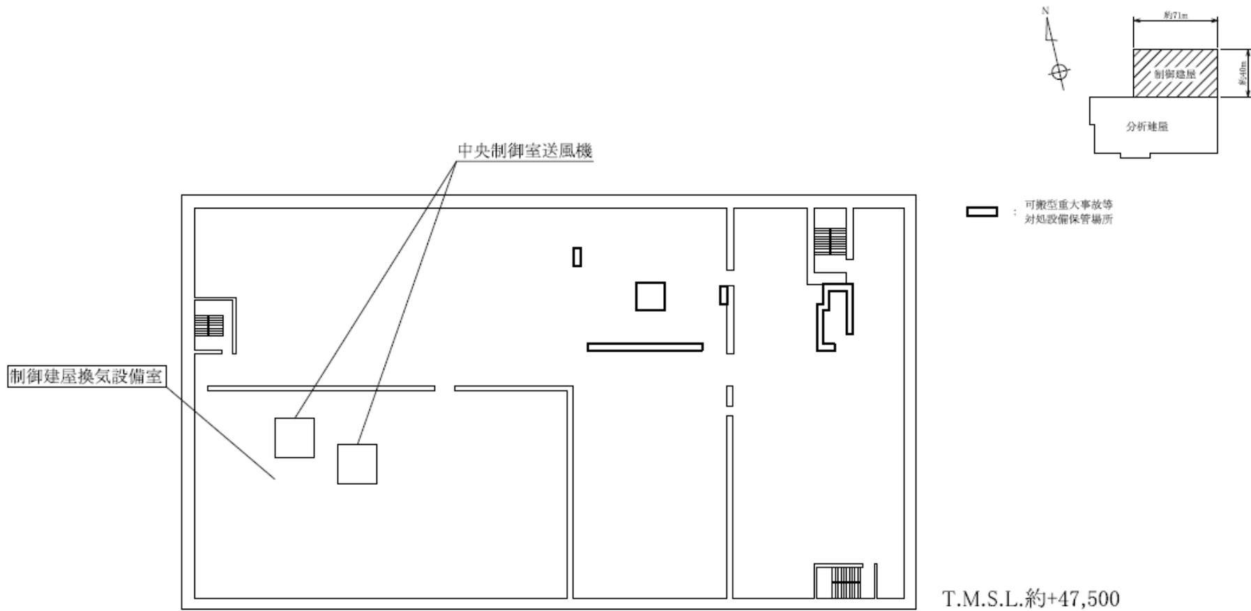
第6.2.5-4図 中央制御室の重大事故等対処設備の機器配置概要図（制御建屋 地下1階）
