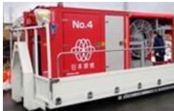
可搬型発電機
