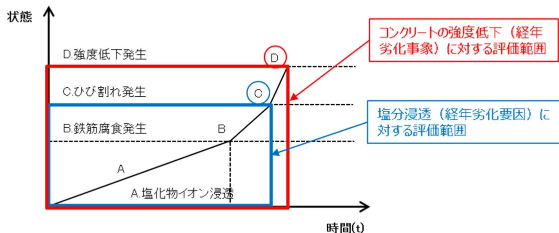
図 4.2-2 塩分浸透による影響の概念図
