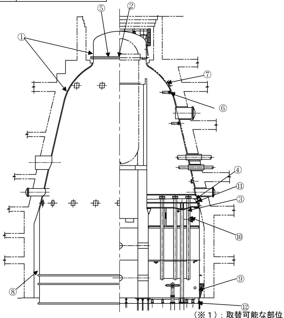
図 3.2-2 代表的な原子炉格納容器 (BWR Mark-II) の構造
