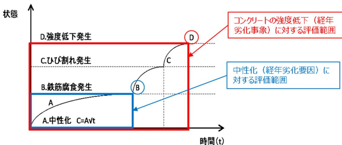
図 4.2-1 中性化による影響の概念図
