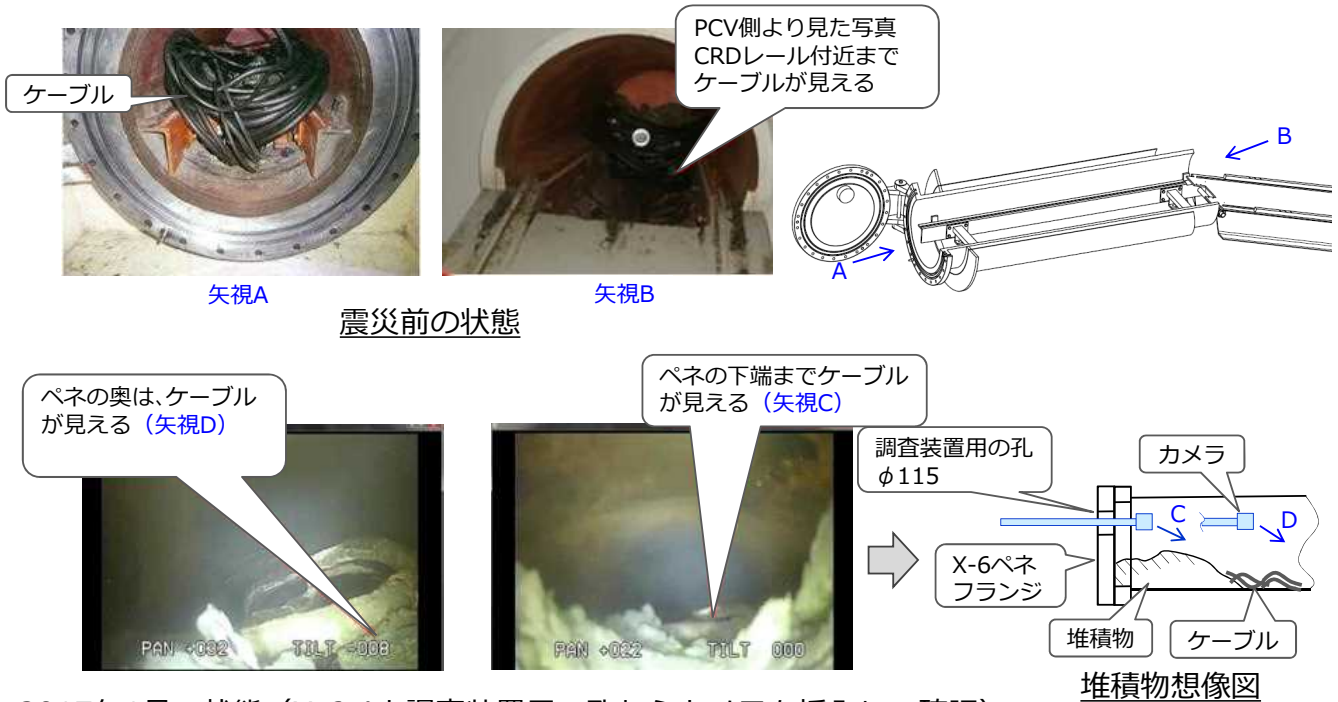
2017年1月の状態 (X-6ペネ調査装置用の孔からカメラを挿入して確認)
