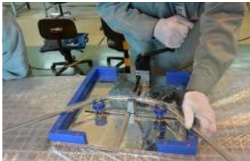
専用治具による曲げ戻しモックアップ (棒の全長をビニールチューブで覆う)
