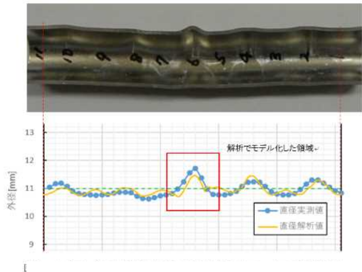
曲げ戻し後の被覆管断面と外径プロフィール
