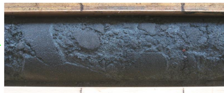
上盤側の凝灰質砂岩が角礫状(砂質の基質を伴う)
