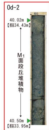
粗~極粗粒砂層 φ1cm以下の円礫含む。 φ5cmの砂岩礫あり。
