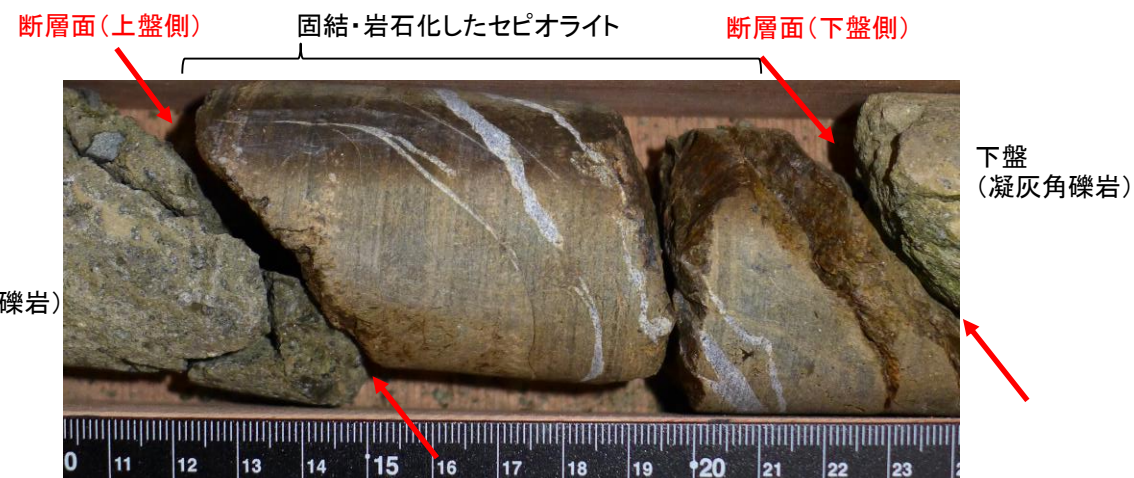
断層面と概ね平行な石英(玉髓)脈
