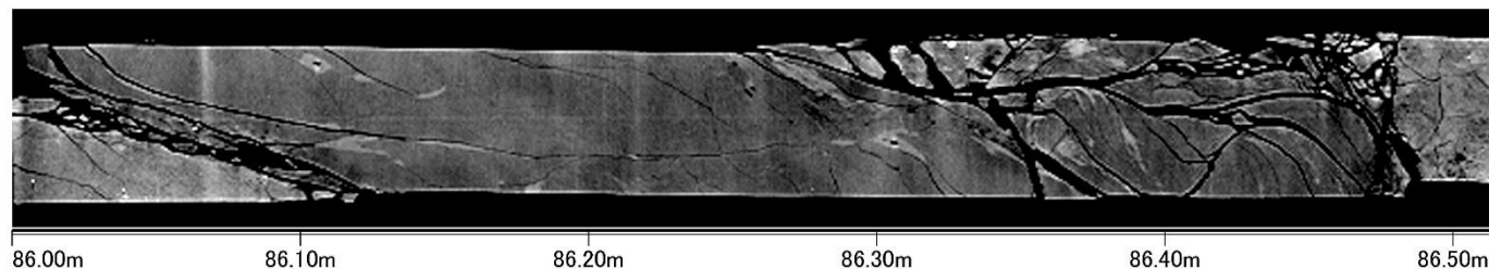
F-4断層: K-16孔, 深度86.00~86.52mCT画像(傾斜方向)
