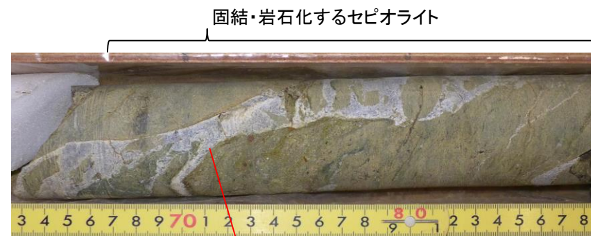
断層面(上盤側) F-4断層 固結・岩石化したセピオライト 下図拡大写真①範囲 断層面(下盤側) F-4断層 固結・岩石化したセピオライト 下図拡大写真②範囲 F-4断層: K-1孔深度7~9mコア写真(平成29年撮影) ※コアが回転し方向が様々な状態のため、断層面の方向が明瞭ではない。
