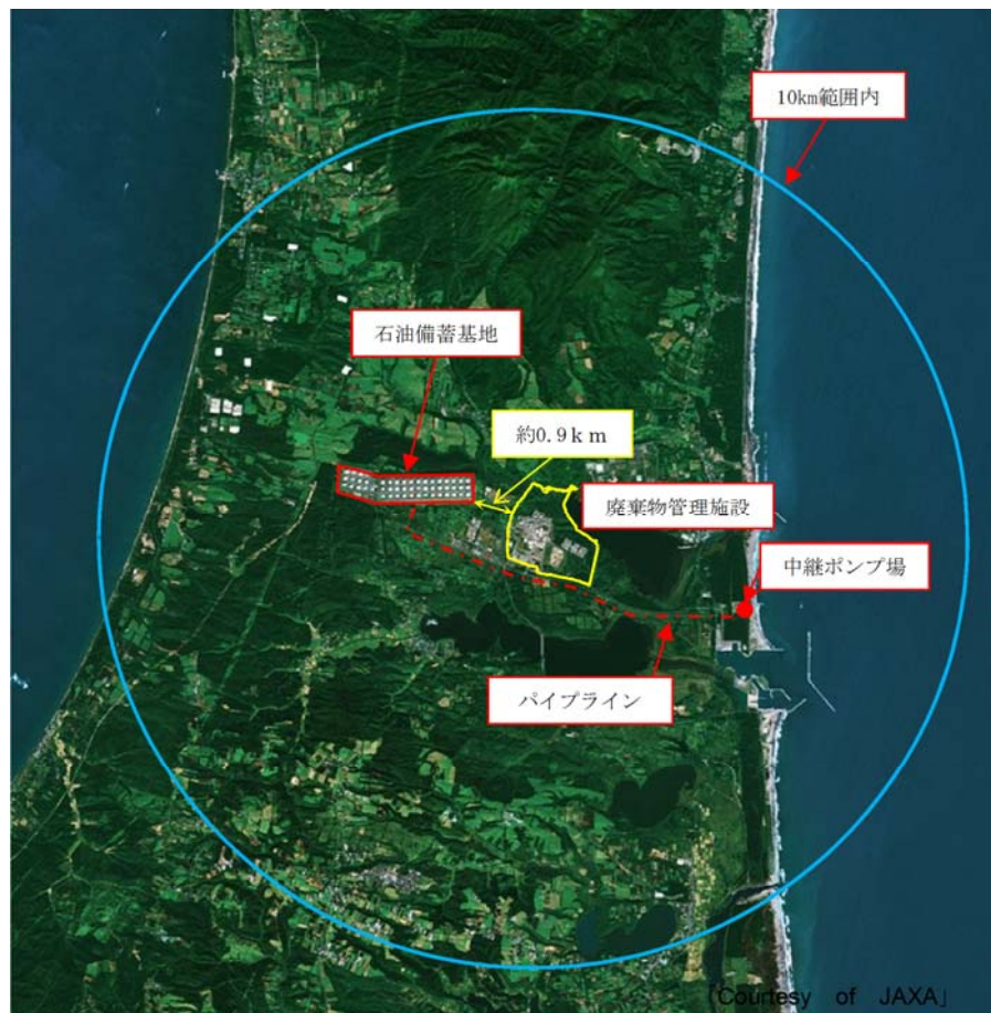
第 2 図 石油コンビナート等特別防災区域内となる施設の配
