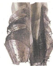
図3 残留磁気による実機模擬接手部への マグネタイト付着の様子
