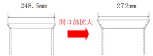
点検装置ラック開口寸法の拡大
