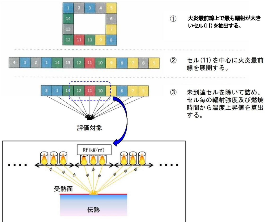
第4-4図 熱影響評価における火炎到達幅分のセルの配置概要
