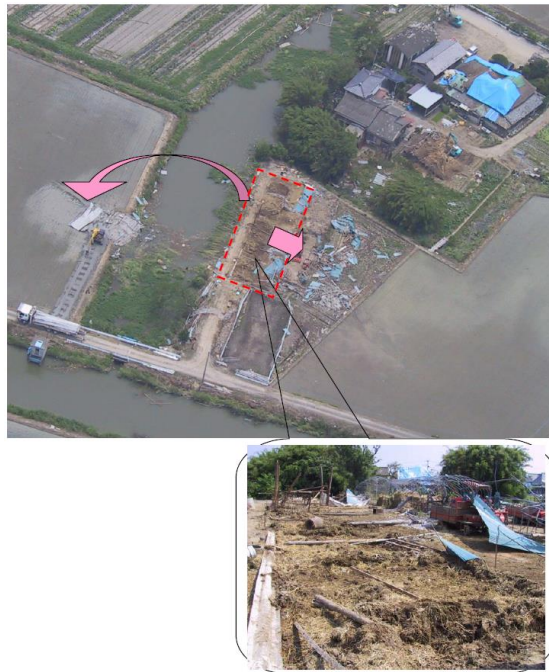
第1図 平成16年6月27日佐賀県で発生した F2竜巻による屋外屋根の被害状況 (1)
