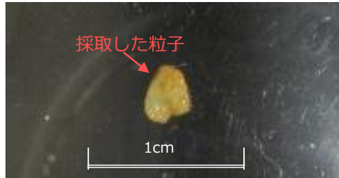
PMBゼオライト土囊から採取した粒子 (拡大) (2020/2/12)
