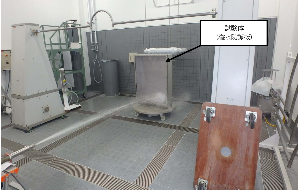
第2図 被水試験の例 (溢水防護板)
