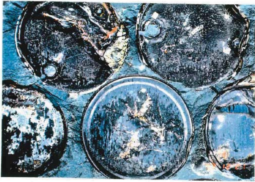
第 12 図 セメント系充填材部分の解体状況(模擬廃棄体間の間隙部の状況)
