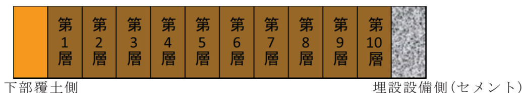
第 1412 図 難透水性覆土の層の定義
