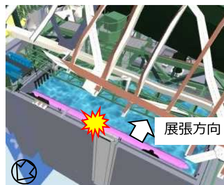
養生バッグ投入完了
