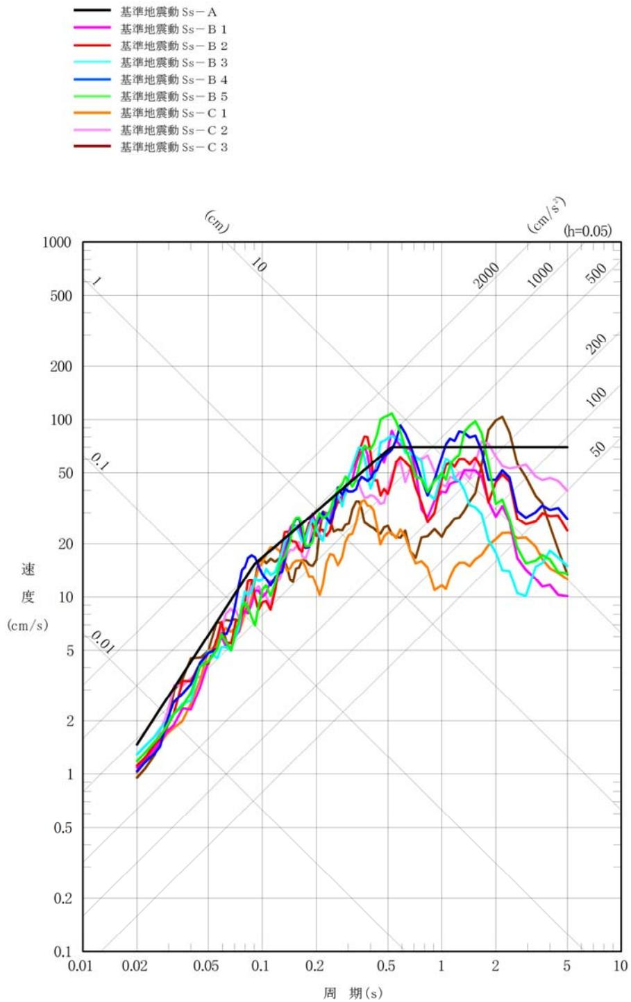
第 3 図 (2) 基準地震動の応答スペクトル (鉛直方向)
