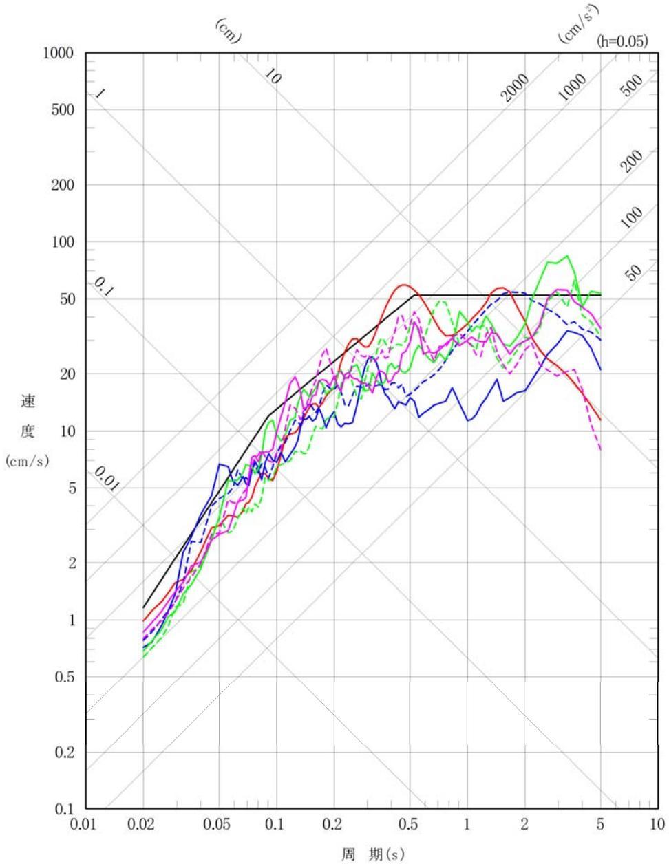
※) 基準地震動 Ss-C 4 は水平方向のみの地震動であることから、基準地震動 Ss-C 4 (水平方向) に対し、鉛直方向の地震力と組み合わせた影響評価を行う場合には、添5第16図及び添5第17図に示す一関東評価用地震動 (鉛直) を用いる。また、弾性設計用地震動 Sd-C 4 (水平方向) と組み合わせる場合には、本地震波に 0.5 を乗じた地震動を用いる。
