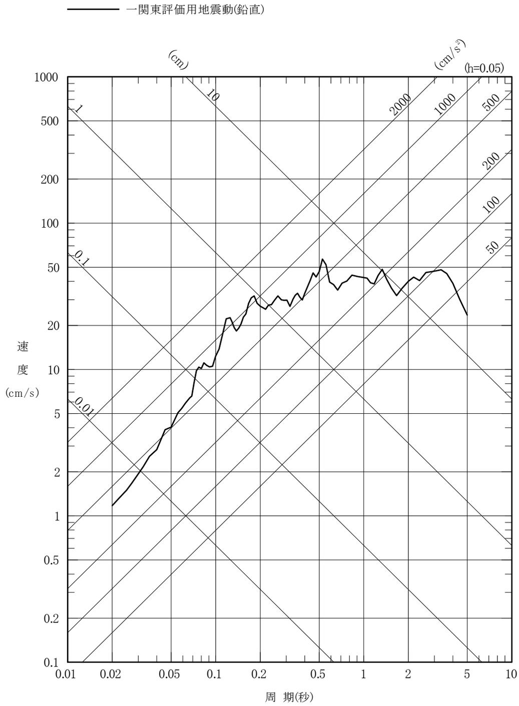
添5第16図 一関東評価用地震動(鉛直)の設計用応答スペクトル
